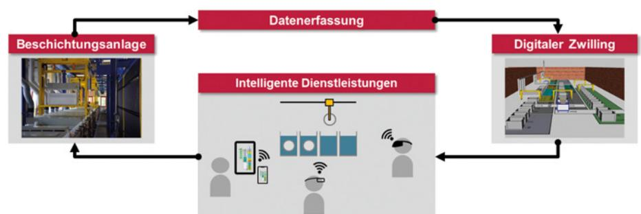
**Abb. 2: Cyber-phisches Produktionssystem als Grundlage für intelligente Dienstleistungen (Quelle: IWF, TU Braunschweig)**
