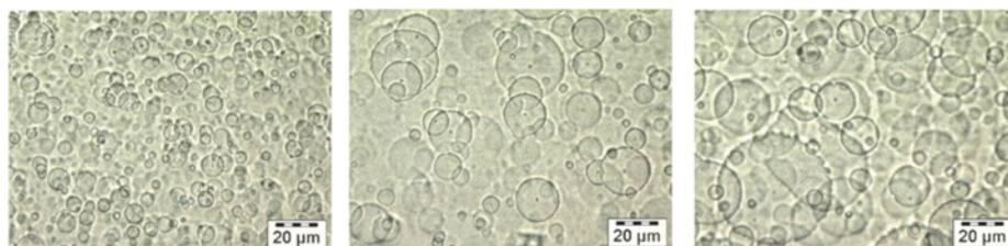
**Abb. 2:** Die Nickelstruktur und daraus folgend der Glanzgrad wird maßgeblich durch Größe sowie Anzahl der Tröpfchen bestimmt (Quelle: MacDermid Enthone)
