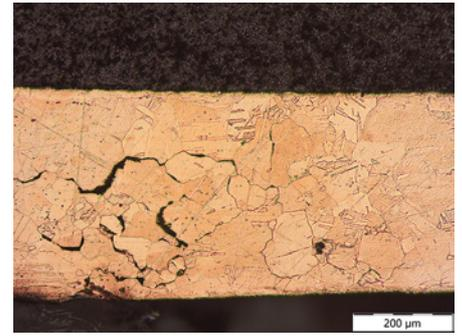
**Abb. 4: Metallographische Schlichtbilder einer Legierung CuZn38As mit Ausfall aufgrund von Spannungsrisskorrosion, interkristallin verlaufend; ungetätzt metallographischer Schlicht (links) und getätzter metallographischer Schlicht (rechts)**
