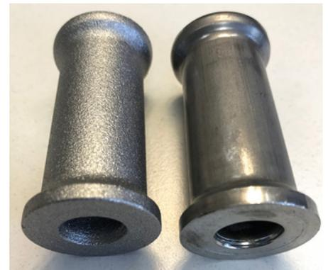
**Raustrahlen kommt beispielsweise bei Innenhülsen aus dem Pkw-Bereich (vor und nach der Behandlung) zum Einsatz (Bild: KST)**
