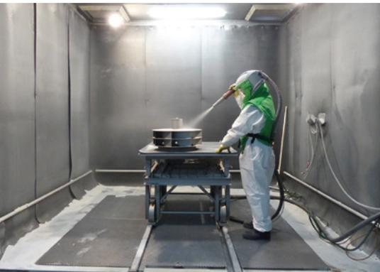
**Für jedes Produkt wird der beste Rauheitswert ermittelt; entscheidend für das Ergebnis sind Strahlmittel und Kornform, Strahldruck und -geschwindigkeit (Bild: KST)**
