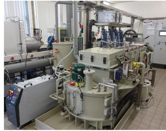
**Die Technikumsanlage erlaubt präzise die galvanische Abscheidung von Elektrodenfolie für den Einsatz in Akkumulatoren, ist aber trotzdem ausreichend flexibel für die schnelle und einfache Optimierung der Anlagenparameter zur Modifizierung des Prozesses** (Bild: Hochschule Aalen)
