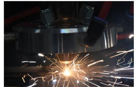
**Hightech in der Uni Bremen: Beim Laserauftragschweißen werden im 3D-Druckverfahren metallische Teile und Strukturen hergestellt (Bild: Anika Langebeck, Bias GmbH)**
