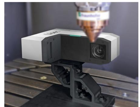
**Das Fraunhofer-IWS-Messgerät Llsec erlaubt eine deutlich vereinfachte Qualitätskontrolle und ermöglicht Rückschlüsse auf den Grad des Verschleißes einer Pulverdüse** (© Fraunhofer IWS Dresden)
