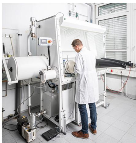
**Das Arbeiten mit Lithiumbatterien erfordert die Nutzung einer Glove-Box zur Abschirmung gegen die Einwirkung von Luft**
