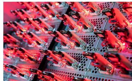
**In der Wacker-Konzernforschung werden bei konstanter Temperatur Lithiumionen-Batterien auf ihre Stabilität geprüft (Bild: Wacker)**
