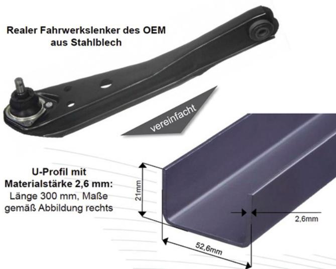
Abb. 1: Die für die Studie erstellte vereinfachte Form eines Fahrwerklenkers, bestehend aus U-Profil mit Materialstärke 2,6 mm (Länge 300 mm) (Bildquelle: acs - Automotive Center Südwestfalen GmbH)
