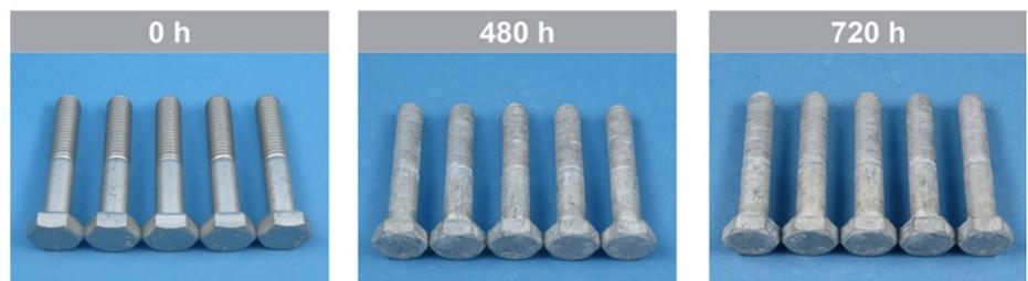
Bereits eine einschichtige Zinklamellenbeschichtung mit einer Dicke von nur 7 µm zeigt im Salzpülttest gemäß ISO 9227 eine hohe Beständigkeit (Bild: A. Fink)
