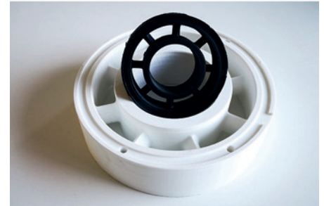
Abb. 2: Kunststoffmodell von Kundenteilen als Basis für die Vorarbeiten zur galvanischen Beschichtung
