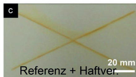
Am Beispiel eines kommerziellen Systems zeigt sich die Wirkung von mehrstufigen Schutzsystemen bei Einwirkung von Salzwasser über einen Zeitraum von 120 Stunden (Bild: Winkler)
