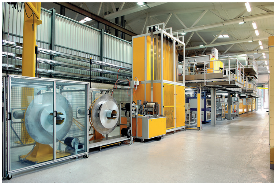
Abb. 2: Die vor zwölf Jahren neu gebaute Lackieranlage von Griesser kommt aufgrund des Einsatzes von AD-Plasma ohne eine nasschemische Reinigungsstraße aus (Bild: Plasmatrete)
