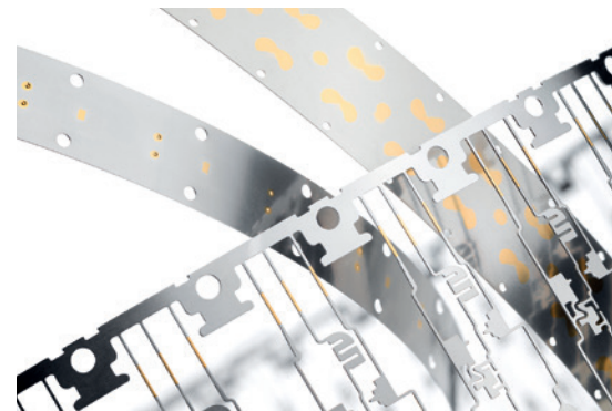
Abb. 3: Mittels Spottechnik beschichtete Vollbänder und Stanzgitter
