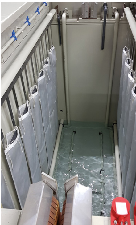
Abb. 3: Ausstattung des Behälters mit Mischoxidanoden (links) und neue Verrohrung der Anlage
