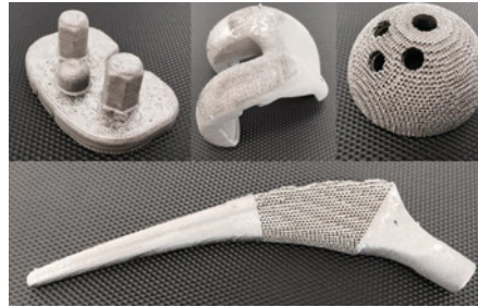
Abb. 2: Verschiedene Implantate aus Tantal-Titan-Legierungen [18]
