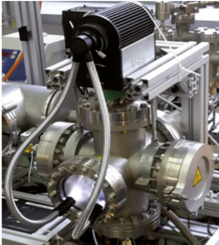
Abb. 2: Kleinvakuumofen mit Schaufenster
