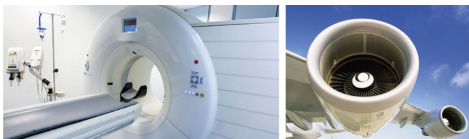
Abb. 3: MRT-Gerät mit Niob-Titan-Magneten (links [19]) und Gasturbine eines Flugzeugs mit Schaufeln aus Tantal-Niob-Legierung (rechts [20])
