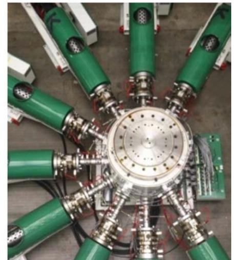
Luftgekühlte Blasfolien (Smart Bubble®) mit Kalibrierkopf (links) und Smart Bubble® mit 9-Schicht-Extruder (© Kuhne Group)
