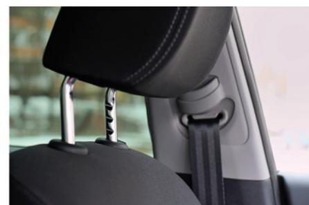
Anwendungsmöglichkeiten der neuen Chromoberfläche auf Basis eines Chrom(III)elektrolyten in Außen- und Innenbereich von Fahrzeugen: Außenspiegel, Armaturenbereich und Kopfstützenhalterung
