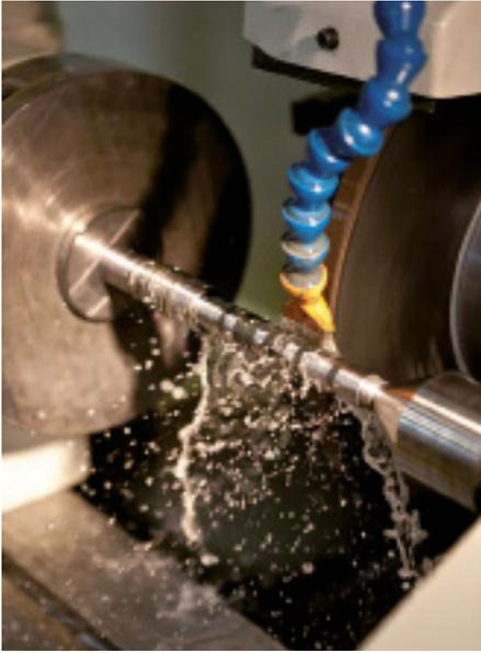
**Schleifen eines beschichteten Bauteils**
