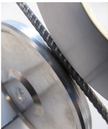
Eine von zahlreichen Einsatzmöglichkeiten der reibwerterhöhenden Oberflächen ist die schlupffreie Übertragung von Kräften zwischen Draht und Laufrad in einem Messsystem
