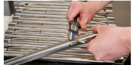
Mittels HVOF beschichtete Bauteile
