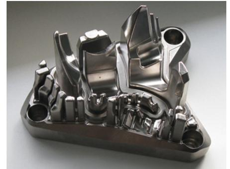
**Lasergeneriertes Werkzeug nach der Beschichtung mit PlanoTek®KSCN**
