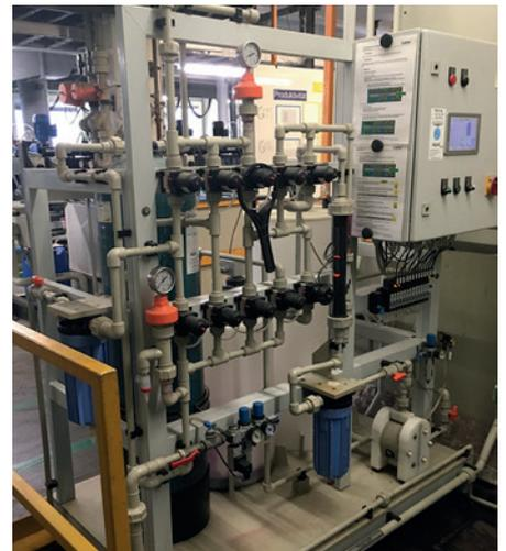
**Anlage der aqua plus GmbH zur Fremdmetalabscheidung aus Chrom(III)elektrolyten [19]**
