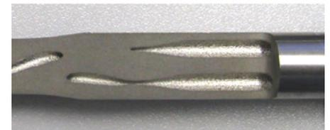
**Ohne Beschichtung verstopfen Kühlkanäle im Einsatz und können nicht mehr repariert werden (oben); Werkzeuge aus dem Werkstoff 1.2709 mit 50  $\mu\text{m}$  PlanoTek KSCN zeigen diese Schädigung nicht**
