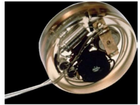
**Abb. 5: Wasserdurchlässigkeit verschiedener Materialklassen (links) ausgedrückt als Dauer, bis die Luftfeuchtigkeit in einem geschlossenen Gehäuse 50 % der Außenluftfeuchtigkeit bei den gegebenen Wändicken erreicht (modifiziert nach [14]) sowie erster implantierbarer Herzschritt-macher mit Epoxidharz-Verkapselung (rechts) [6]**
