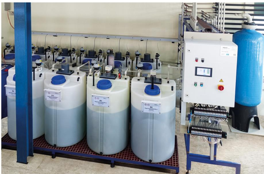
**Ionenaustauscheranlage zur Wartung von sechs Passivierungssystemen, wie sie seit einiger Zeit bei der Knoblauch Galvanotechnik GmbH in Geislingen mit sehr gutem Ergebnis in Betrieb ist**
