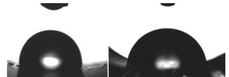
**Abb. 1: Wassertropfen in sprühsilikonisierter (links) und hydrophob beschichteter Spritze (rechts)**
