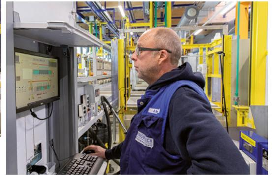
Ansichten des neuen Galvanoautomaten bei der Knoblauch Galvano-technik GmbH zur Abscheidung von Zink-Nickel auf Schüttgutteile und Einzelteile in Gestelltechnik
