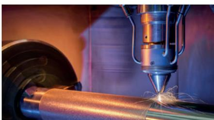
**Aufrüstung: Eine Drehbank wird durch Integration von Laserstrahlquelle, EHLA-Bearbeitungskopf und Pulverzufuhrsystem zur extrem schnellen Anlage zum Laserauftragen**
