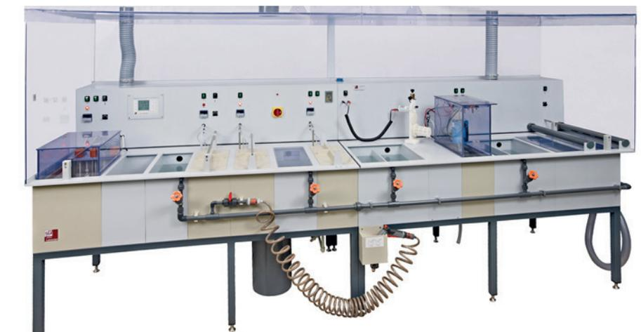
**Abb. 6: Galvanikanlage (manuell) zum Farbanodisieren, Vorbehandlung Ultraschall und Beizen, Elektropolieren von Edelstahl oder Titan, Passivieren, Spülen und Trocknen**
