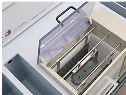
**Abb. 4: Korb zum Anodisieren von medizinischen Kleinteilen**
