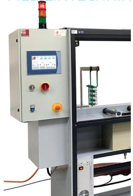
**Abb.: 8: Detailsicht der COMPACTA, semi-automatisiert mit SPS Steuerung**
