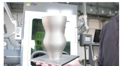
**Metall-3D-Drucker mit DED-Technologie erlauben es, komplex geformte, dünnwandige Werkstücke in sehr kurzer Zeit zu fertigen**
