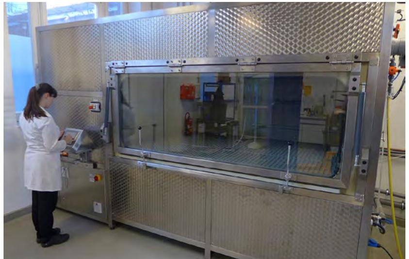
seltest nach DIN EN ISO 11997-1 Zyklus B (früher: VDA 621-415) geeignet. Vor Inbetriebnahme wurden die Geräteeinstellungen der Kammer eingehend geprüft und die Eignung der programmierten Korrosionsprüfabläufe getestet. Die Funktions- beziehungsweise Korrosivitätsprüfung nach DIN EN ISO 9227 NSS wurde erfolgreich absolviert, sodass ab sofort akkreditierte Prüfungen durchgeführt werden können. Dabei kann man auch auf spezielle Kundenwünsche eingehen und Programme individuell erstellen.
