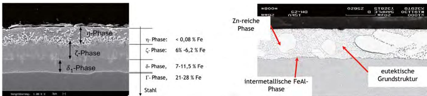
Schichtstruktur bei Zink-Eisen (oben) und Zink-Aluminium-Schichten (unten)
