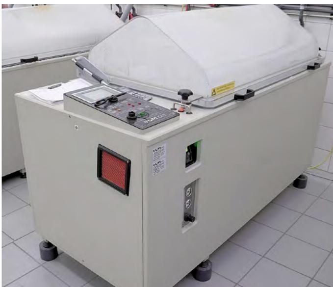
Abb. 1: Prüfkammer für den Salzsprühnebeltest gemäß DIN EN ISO 9227
