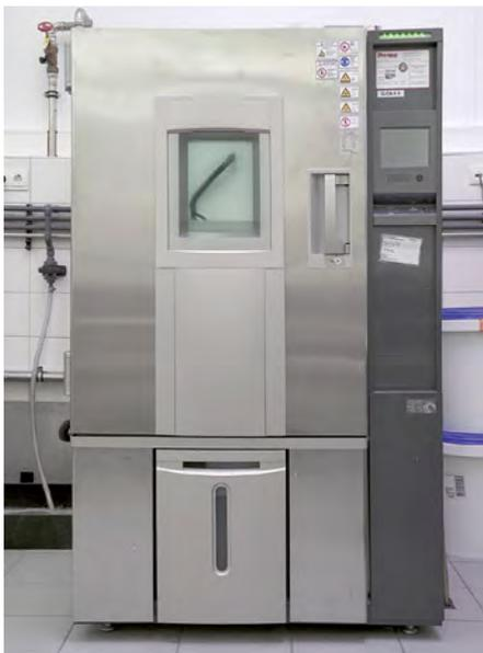
**Abb. 3: Prüfkammer für den Klimawechseltest**
