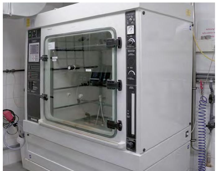
Abb. 2: Prüfkammer für die Tests ACT I und ACT II von Volvo sowie L467 von Ford
