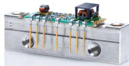
**Mit der Nickelbeschichtung nach dem Verfahren (c)lean können umweltfreundlichere Lötpasten genutzt werden, als bei konventionellen chemisch abscheidenden Verfahren; das Reinigen nach dem Lötvorgang kann entfallen**
