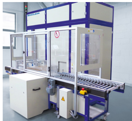
Die kompakte Minio 85C ermöglicht die zuverlässige und wirtschaftliche Entfettung und Reinigung mit nicht-halogeniertem Kohlenwasserstoff zwischen oder nach Fertigungsprozessen
