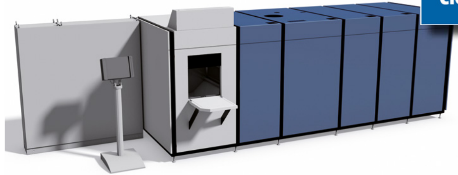
Aduna K100 5-Bad-Ausführung, Filtration im sechsten Modul, Volumen der Reinigungspositionen insgesamt 2.900 Liter (Werksbild: AdunaTEC GmbH, Mainhardt)
