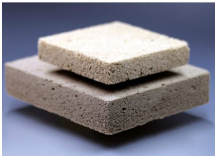
Aus ökologischer Sicht eignen sich Holzschäume sehr gut für eine Vielzahl von Einsatzbereichen (Bild: Fraunhofer WKI)
