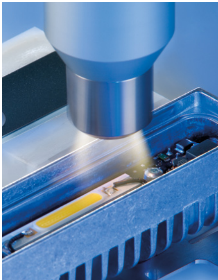
Abb. 2: Umweltfreundlich und ungefährlich für die Elektronik: Statt mit Nasschemikalien werden bei Waldmann die Gehäuse der Maschinenaufbauleuchten vor ihrer Verklebung heute mit potentialfreiem Openair-Plasma® vorbehandelt (Foto: Plasmatreteat)
