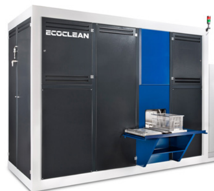
Die Vollvakuum-Lösemittelreinigungsanlage EcoCompact lässt sich durch bis zu drei Flutbehälter und zahlreiche Standardoptionen optimal an die spezifische Aufgabe anpassen
