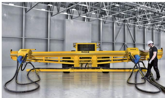
Abb. 3: Mobiler Strahlroboter mit Doppelstrahlausleger
