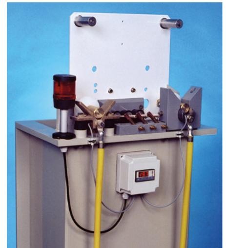
**Das Sicherheitssystem GALVA-SAVE warnt bei Überhitzung der Warenkontaktauflagen und Verschlechterung der Stromübertragung**
