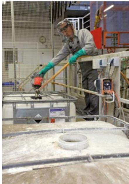
**Abb. 1: Dosieren von Gefahrstoffen mittels Fasspumpe**
