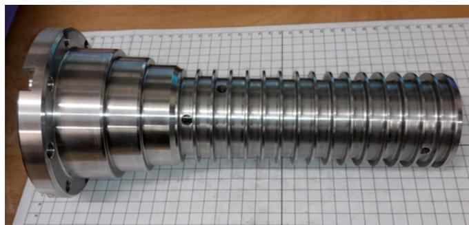
**Abb. 3: PlanoTek®-Korrosionsschutzschicht (Bild: Firma Wilhelm Weber, Esslingen)**
