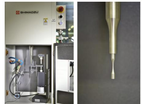
**Abb. 2:** Ultraschall-Ermüdungsprüfsystem Shimadzu-USP-2000 (links) und Prüfspitze mit eingesetzter Schwingprobe (rechts)
