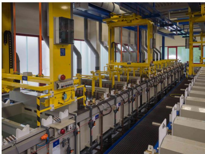
**Der vor kurzem in Betrieb genommene Erweiterungsbau mit modernster Ausstattung verbessert die Arbeitsmöglichkeiten zu Konzipierung und Bau von Anlagen für die galvanotechnische Industrie – hier zwei Beispiele von Trommelanlagen der A.S.T. GmbH**
