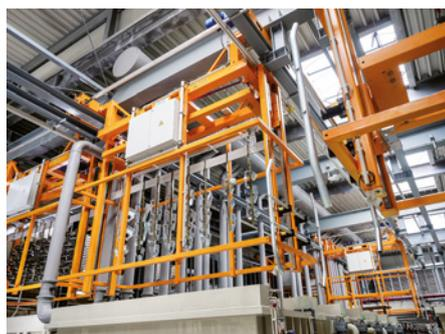
**Die hochleistungsfähige Gestellgalvanik kann auch größere Komponenten mit einem hohen Durchsatz beschichten (Bild: OTN)**
