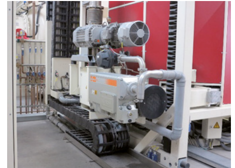
Abb. 1: Vakuumsystem bestehend aus einer R 5 Drehschieber-Vakuumpumpe und einer Puma Wälzkolben-Vakuumpumpe von Busch
