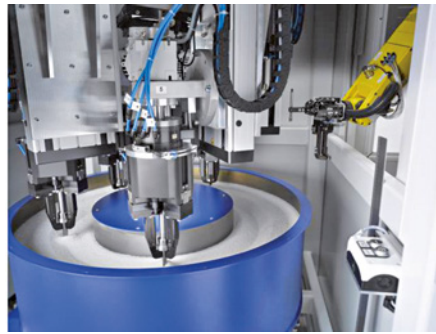
Abb. 9: Bei Technologien wie dem Schleppschleifen (z.B. Pulsfinishing von OTEC) sind die Teile mittels Werkstückträger fixiert und erreichen kurze Bearbeitungszeiten (Bild: OTEC)
