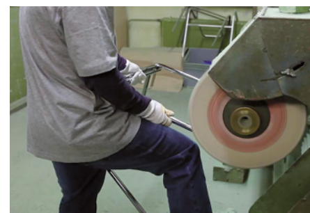
Abb. 8: Beispiel für manuelles Schleifen und Polieren (Bild: LKS Kronenbergert)
