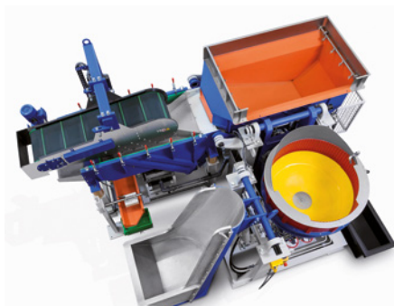
Abb. 7: Automatisierte Anlagentechnik für das Gleitschleifen (Bild: Walther Trowal)
