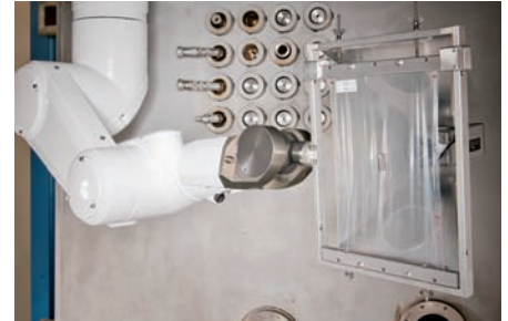
Sterilisation einer Implantatschraube mittels Elektronenstrahltechnologie und 3D-Handling (© Fraunhofer FEP)
