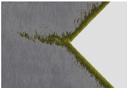
Rissfortschritt in der Kerbe einer faserverstärkten Kunststoffprobe
