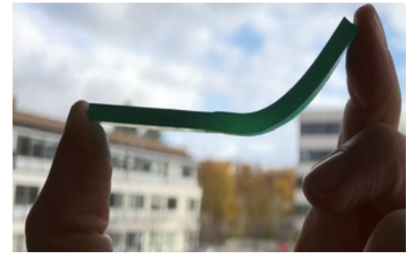
Biigsam und hart in einem Stück: das neue Kunststoff-Metamaterial (© Fraunhofer LBF)
