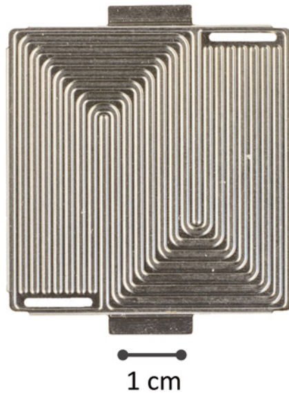
Abb. 2: Bipolarplatte aus DC04 mit eingestanztem Strömungsfeld und einer Blechdicke von 0,1 mm
