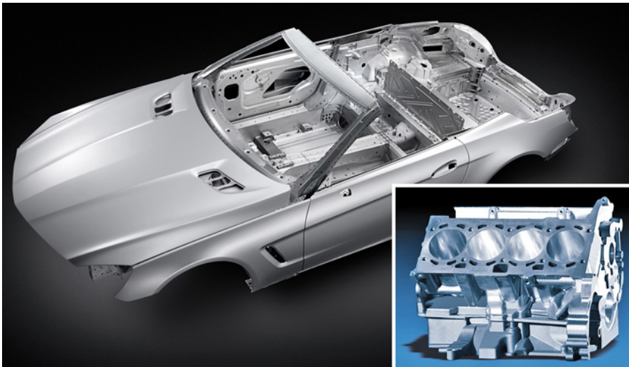
Im Fahrzeugbau kommt Aluminium sowohl für funktionelle Teile wie den Motorblock als auch für die dekorative Anwendung wie die Außenhaut der Karosserie zum Einsatz [10, 11]
