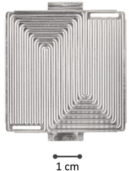
Abb. 3: Bipolarplatte nach der Verchromung in einem chrom(III)haltigen Elektrolyten der Professur Werkstoff- und Oberflächentechnik
