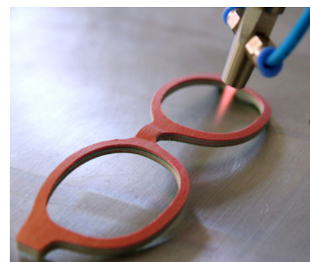
Abb. 1: Jet-Plasmabehandlung eines Holz-Brillengestells
