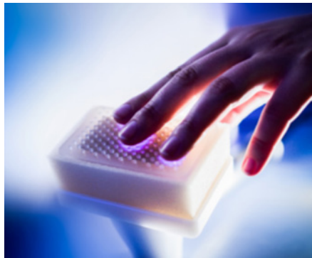
Abb. 1: Flächenplasmaquelle PlasmaDerm®, mit der ein kaltes Plasma direkt auf der Haut erzeugt werden kann (Quelle: Fraunhofer IST)
