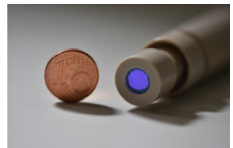
Abb. 3: Mikroplasmaquelle für die lokale Anwendung flüchtiger Plasmen (Quelle: Michael Fischer, Ady Naber, Technische Universität Ilmenau)
