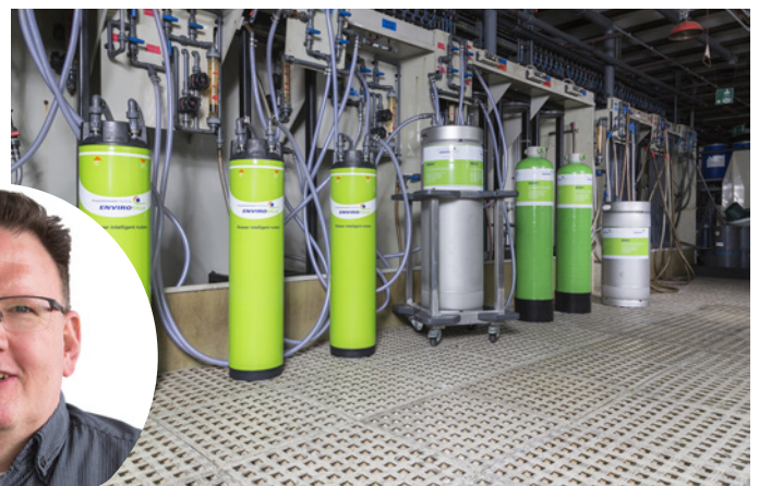
Einzelplatzregeneration für mobile Selektivionenaustauscher in der Enviro-FALK-Niederlassung in Birkenfeld, geleitet von Guido Grünjes
