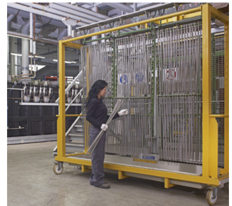
Bei der Beschichtung im gestreckten Zustand können die Warenträger der Beschichtungsanlagen effektiver belegt und höhere Stückzahlen beschichtet werden
