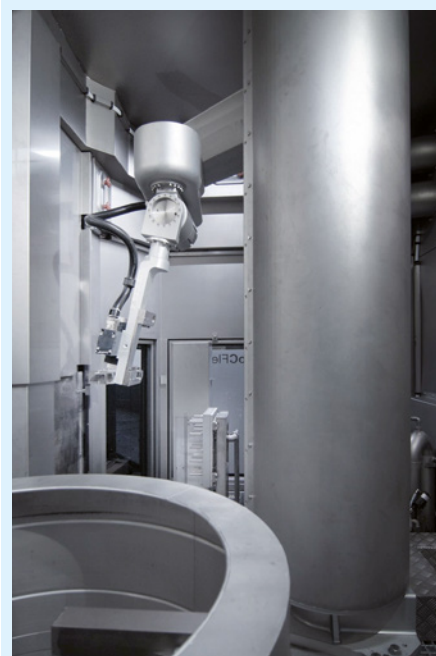
Links: Die Roboterzelle ist mit einem speziell für den Einsatz in Reinigungsanlagen entwickelten Scara-Manipulator und einer gemeinsamen CNC-Steuerung für Manipulator und Reinigungsanlage ausgestattet (Bild: Dürr Ecoclean). Rechts oben: Die optimale Abstimmung von Chemie, Anlagen und Verfahrenstechnik auf Bauteil, Verschmutzung und Sauberkeitsanforderungen ist Voraussetzung für prozesssichere und effiziente Reinigungsprozesse (Bild: MAFAC). Rechts unten: Für die Reinigung von Großmotorteilen, etwa Zylinderkurbelgehäuse für Baumaschinen, wurde diese Roboterzelle entwickelt (Bild: Sturm)
