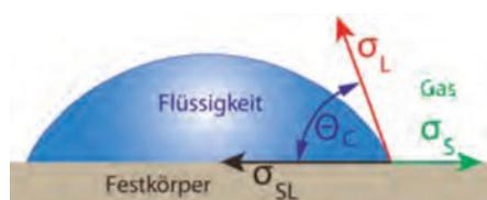
**Abb. 1: Schematische Darstellung eines Kontaktwinkels  $\theta_c$  auf einer Festkörperoberfläche, mit der Oberflächenspannung der Flüssigkeit  $\sigma_L$ , Oberflächenenergie des Festkörpers  $\sigma_S$  und fest-flüssig-Grenzflächenenergie  $\sigma_{SL}$ .**
