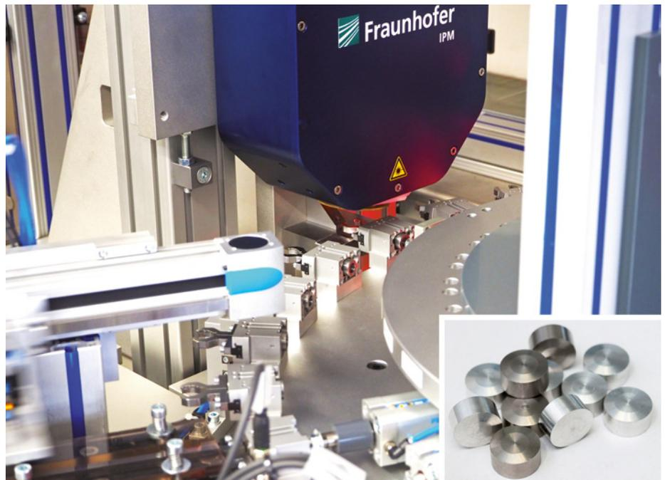
**Abb. 1:** Das Inline-3D-Inspektionssystem HoloTop lässt sich direkt in die Fertigungslinie integrieren und vermisst 3D-Oberflächen mit 10 Megapixel Auflösung und 10 Hz Aufnahme Frequenz
