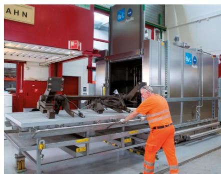
**Die komfortable Beschickung der Reinigungsanlage erfolgt über einen verschiebbaren Rollwagen**
