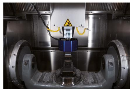
**Abb. 3: Eine spezielle, sehr kompakte Ausführung des HoloTop-Sensors kann direkt in Werkzeugmaschinen integriert werden (blaues Gehäuse, hier in einer 5-Achs-CNC-Fräsmaschine)**
