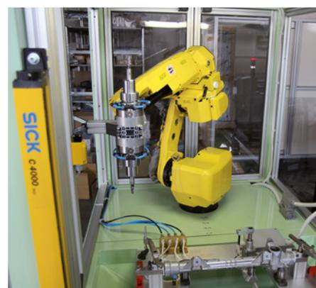
**RSC-System am Roboter und fixiertem Bauteil**
