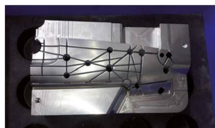
mungsproblemen im Bereich der Rippen. Die Einsätze wurden mit 5 µm PlanoTek CNBV beschichtet. Nach der Beschichtung wurden die Auswerferkräfte halbiert und die Entformung hat sich erheblich verbessert.
