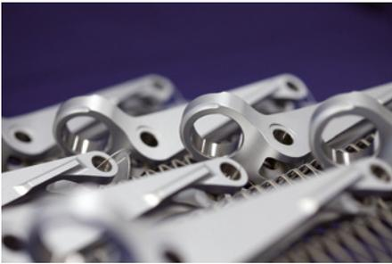
**IVD-beschichtete Bauteile mit Maskierung im inneren Durchmesser, die nach der Aluminiumbeschichtung passiviert wurden**
