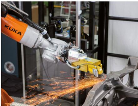
**Abb. 1:** Durch roboterbasierte Nachbearbeitung können Mitarbeiter von körperlich anstrengender und gefährdender Arbeit deutlich entlastet werden
