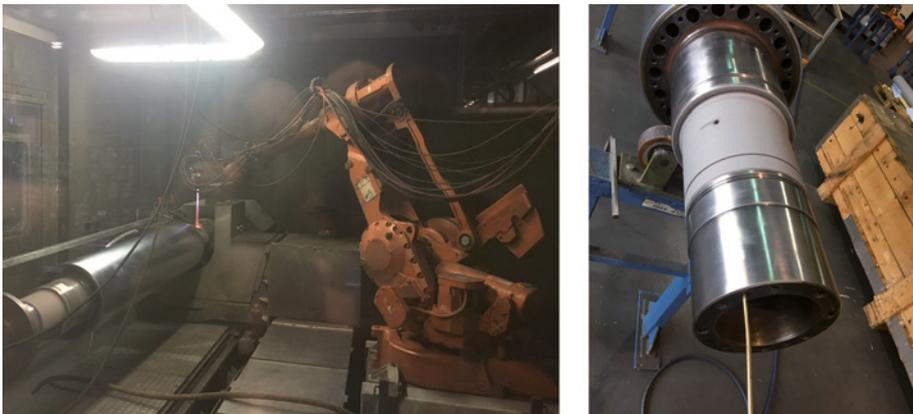
**Abb. 4: Revision von Lagerstellen mit hochlegiertem Edelstahl (links), spritzraue Beschichtung auf Wellenzapfen (rechts)**
