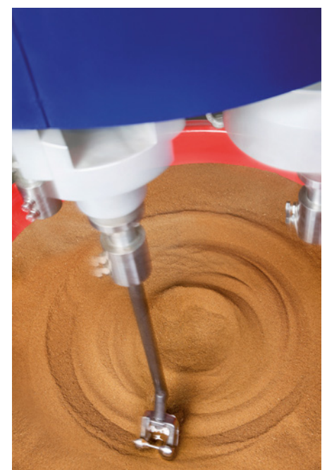
Ein Werkstück kurz vor dem Absenken in das Schleifmedium
