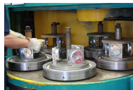
Anlagenbestückung mit Aluminiumteilen zum thermischen Entgraten (Bild: Benseler)
