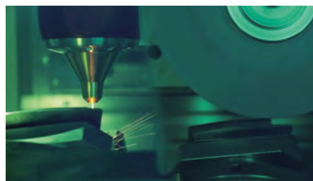
Laserschweißprozess auf Hybridmaschine zum Auftragslaserschweißen und Schleifen
