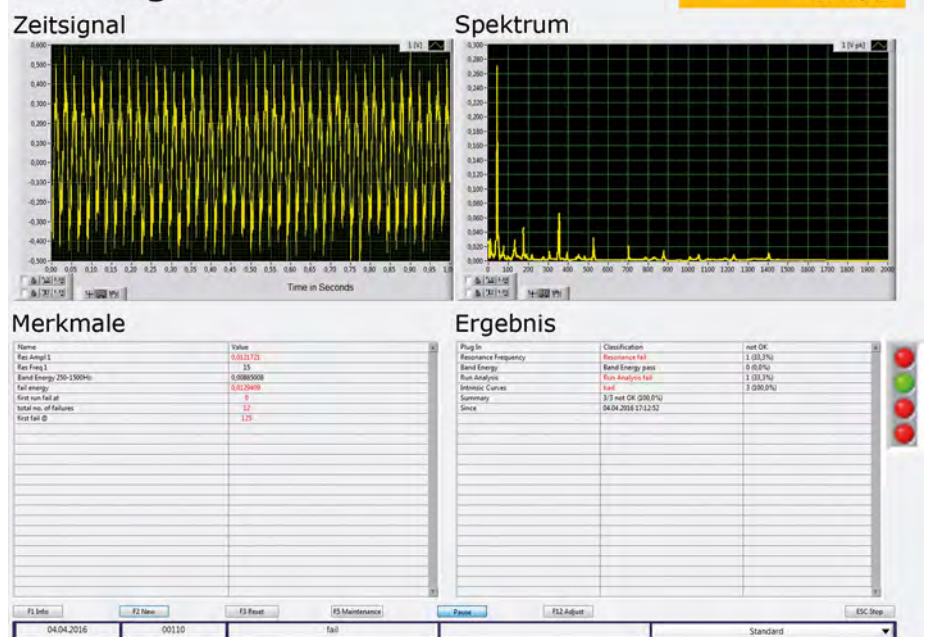
Abb. 5: Die Prüfsoftware QuickCheck ist speziell für die akustische Güteprüfung mit Laservibrometern konzipiert. Sie erfasst die Messsignale des Laservibrometers und anderer, eingesetzter Sensoren und wertet sie aus, steuert den Prüfablauf und kommuniziert mit dem Fertigungsleitsystem (Quelle: Polytec)
