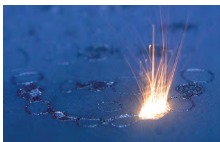
Prozessstufe des Aufschmelzens von Pulver mit Hilfe eines Laserstrahls (Quelle: EOS)
