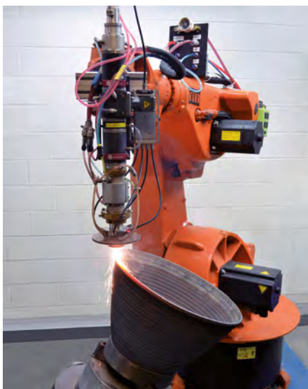
Generative Fertigung eines Luftfahrtmodells mittels Laser-Pulver-Auftragschweißen (© Fraunhofer USA CLA)
