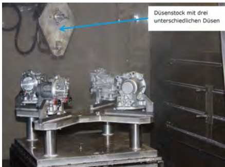
Arbeitsraum einer Anlage zum Hochdruckwasserstrahlentgraten mit Aluminiumdruckgussteilen (Bild: Benseler)
