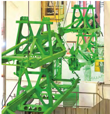
Vor der Pulverbeschichtung durchlaufen diese Stahlteile eine kathodische Tauchlackierung. Die 10 µm bis 40 µm dicke Grundierung ist extrem korrosionsbeständig (Bild: Wagner)
