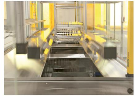
**Die Anlage verfügt über insgesamt elf Stationen; davon sieben Tauchbecken für Reinigungs- und Spülschritte, die flexibel angefahren werden können**
