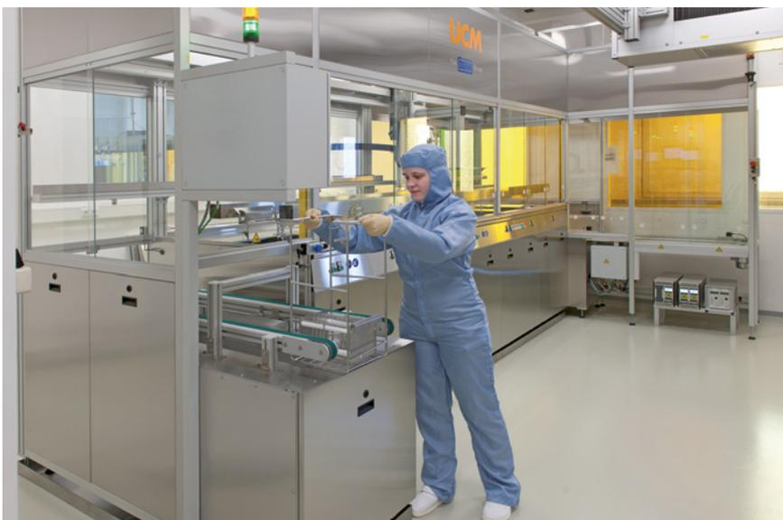
**Die hochflexible Reinigungsanlage ist in einen Reinraum integriert und wird für die Reinigung von un bearbeiteten Substraten sowie nach der Strukturierung und Beschichtung eingesetzt**
