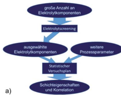
**Abb. 2: Schematische Darstellung der zweistufigen Vorgehensweise zur Elektrolytentwicklung (a) und Spannungsverlauf eines Rampenversuchs (b)**
