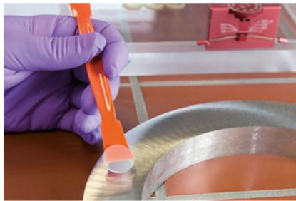
**Applizieren eines KorroPads auf einem Edelstahlring**
