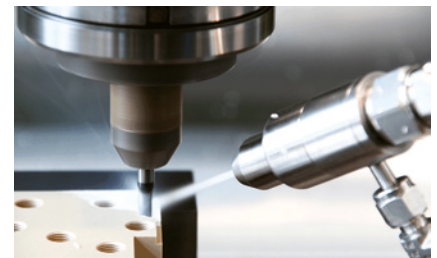
Der Einsatz des CO 2 -Schneestrahlsystems beim Zerspanen von PEEK zum Kühlen, Schmieren und Reinigen führt zur Produktivitätssteigerung und Reduzierung der Bauteilverschmutzung
