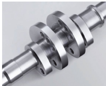
Das Ergebnis des Glättens der Oberfläche von Rz 2,5 µm auf unter 1 µm und Rpk-Wert unter 0,1 µm; Nockenwelle vorher (links) und nachher
