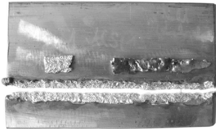
Abb. 1: Auftragsschweißung AlSi12 auf AZ 31
