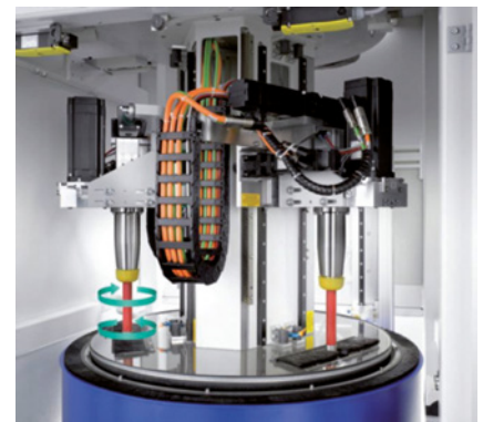
Die oszillierende Spindel wird in einer Sekunde auf 2000 Umdrehungen/min beschleunigt und abgebremst
