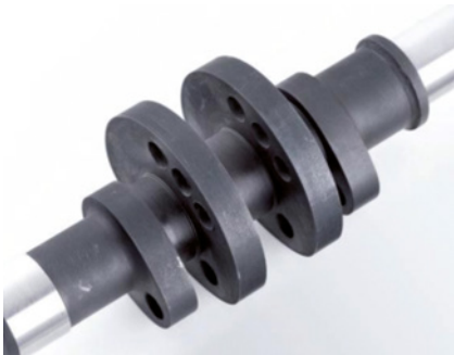
Das Ergebnis des Glättens der Oberfläche von Rz 2,5 µm auf unter 1 µm und Rpk-Wert unter 0,1 µm; Nockenwelle vorher (links) und nachher
