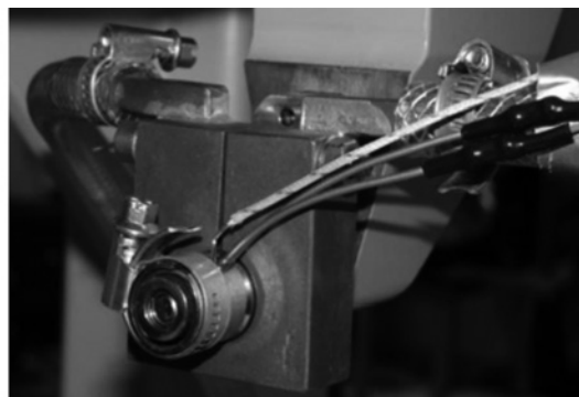
Abb. 4: Induktor (links) und Matrizentemperierung (rechts)
