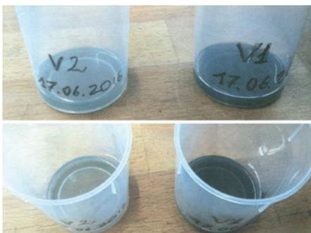
Durch Abrieb wird Dämpfungsöl verunreinigt, erkennbar an der dunklen Färbung
