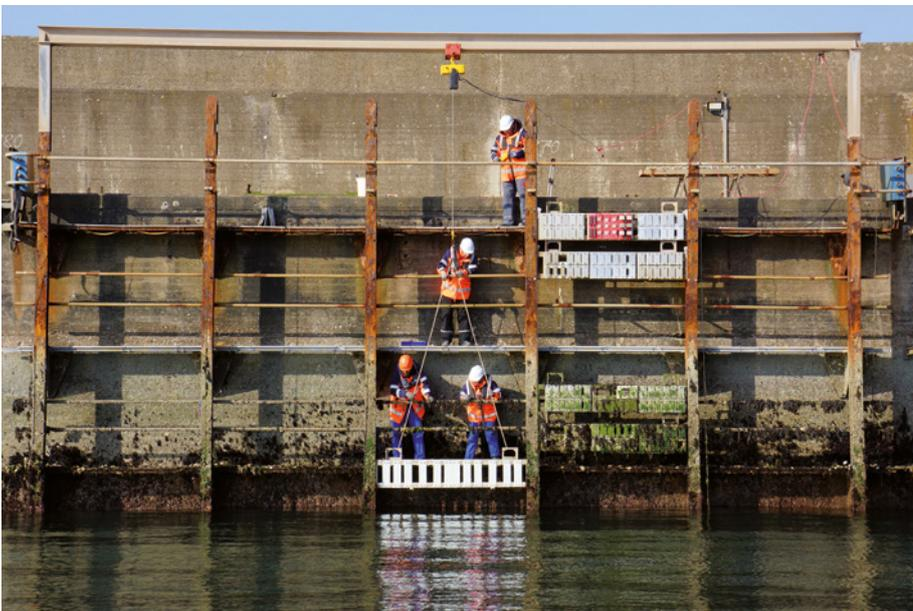
Korrosionsprüfstand für maritime Umgebungsbedingungen
