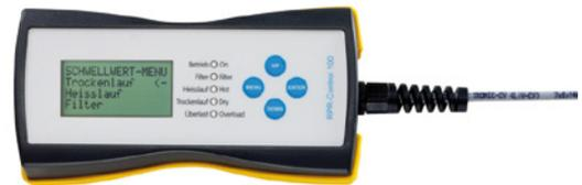
Schnittstelle zur Programmierung des Motors (Abb. 10).
