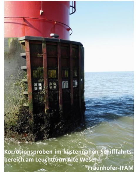
Korrosionsproben im küstennahen Schifffahrtsbereich am Leuchtturm Alte Weser ©Fraunhofer-IFAM
