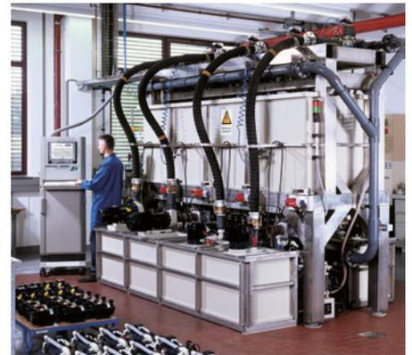
Prüfung von Pumpen bei Renner 28
