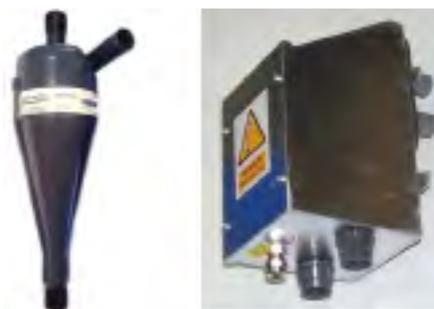
Abb. 11: Zyklon (links) und Lufterhitzer
