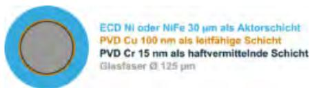
Abb. 2: ECD/PVD-Kombinationsschichtsystem der zwei Basisdesigns Nickel und Nickel-Eisen
