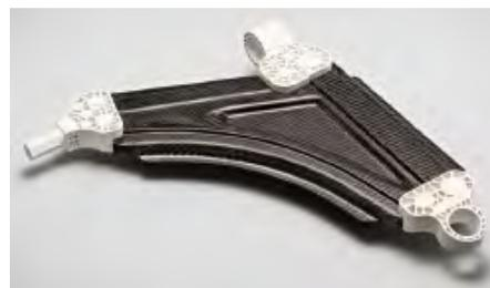
Der Querlenker aus CFK ist bis zu 45 Prozent leichter als ein herkömmliches Bauteil. Sein Zustand wird von einem integrierten Structural-Health-Monitoring-System (SHM) überwacht
