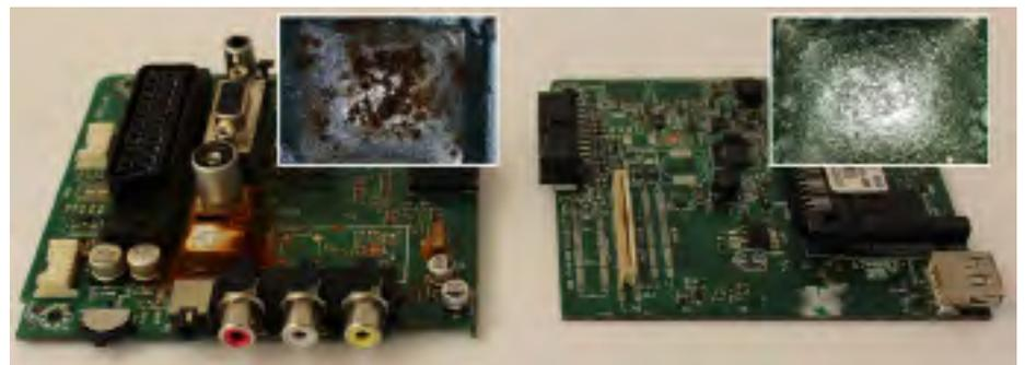
Abb. 1: Unverkapselte und mit circa 5  $\mu\text{m}$  Parylene C verkapselte Leiterplatte nach einer Woche in 5%-iger Salzlösung sowie jeweils ein Kontaktpad
