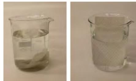
Abb. 5: Beschichtung von klassischem Löschpapier mit circa 2,4 µm Parylene (rechts) sowie Demonstration der Barrierewirkung im Vergleich zu unbeschichtetem Papier im Wasser (links)
