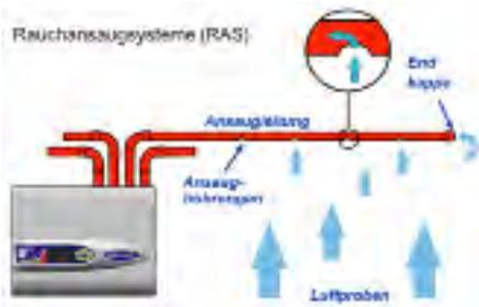
Abb. 1: Komponenten eines Rauchansaugsystems
