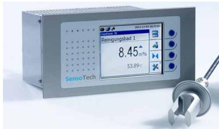
Sensoren den Verschmutzungsgrad in Reinigungsbädern für eine effiziente Steuerung von Badwechseln. Die Technologie basiert auf der Schallgeschwindigkeitsmessung, die durch hohe Messgenauigkeit und robuste Sensorkonstruktion überzeugt. Die Messwerte werden an PCs und Leitsysteme gesendet.
