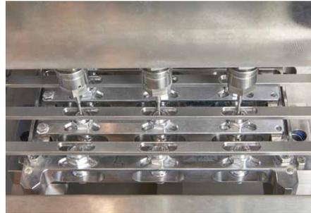
mit zuverlässigen Prozessen für anspruchsvolle Reinigungs- und Entgratergebnisse. Anlagen des Unternehmens entgraten beispielsweise simultan 24 Kleinstbauteile mit präziser HD-Spritztechnologie auf  $\pm 20 \mu\text{m}$  genau. Dafür fahren zum Beispiel 2-mm-Rotationslanzen zeitgleich und berührungslos bei sechs Bauteilen in 3-mm-Bohrungen ein.
