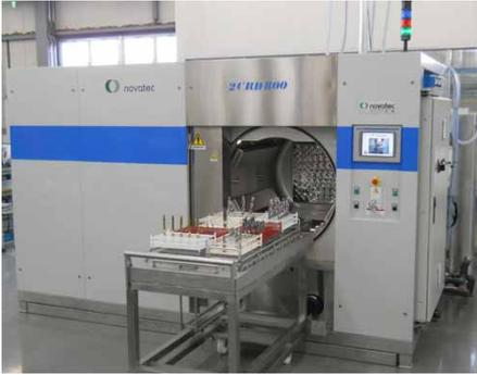
2-CRD-1-Kammeranlagen mit Vakuum von Novatec sind deshalb für alle Teile, auch schwierig zu reinigende Werkstücke, geeignet. Die flexiblen und hoch entwickelten Reinigungssysteme ermöglichen programmierbare Zyklen und die Kombination von Sprüh- und Ultraschallphasen unter Vakuum.
