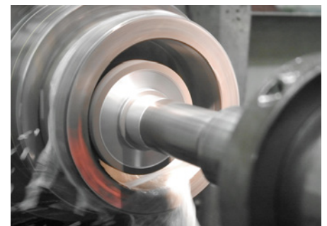
Innenrundsleifen hochlegierter gehärteter Stähle mit kunststoffgebundener CBN-Schleifscheibe
