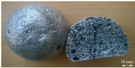
Abb. 2: Aluminiumschaumprobe mit Glasfasern, verstärkt mit 0,5 Gew.-% TiH 2 und 2 Gew.-% GF Quelle: TU Ilmenau, FG MWV
