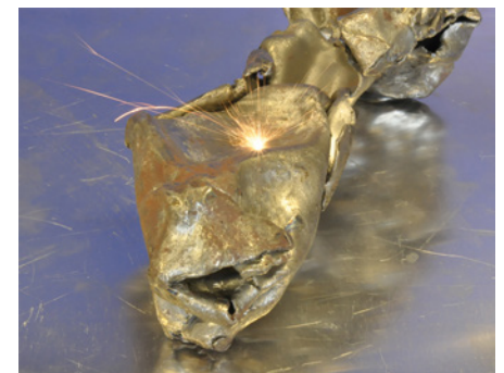
Abb. 4: Werkstofferkennung mittels Lasertechnik
