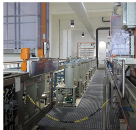
Filtersysteme in der neuen Anlage zur galvanischen Kunststoffbeschichtung bei der KT Bernt
