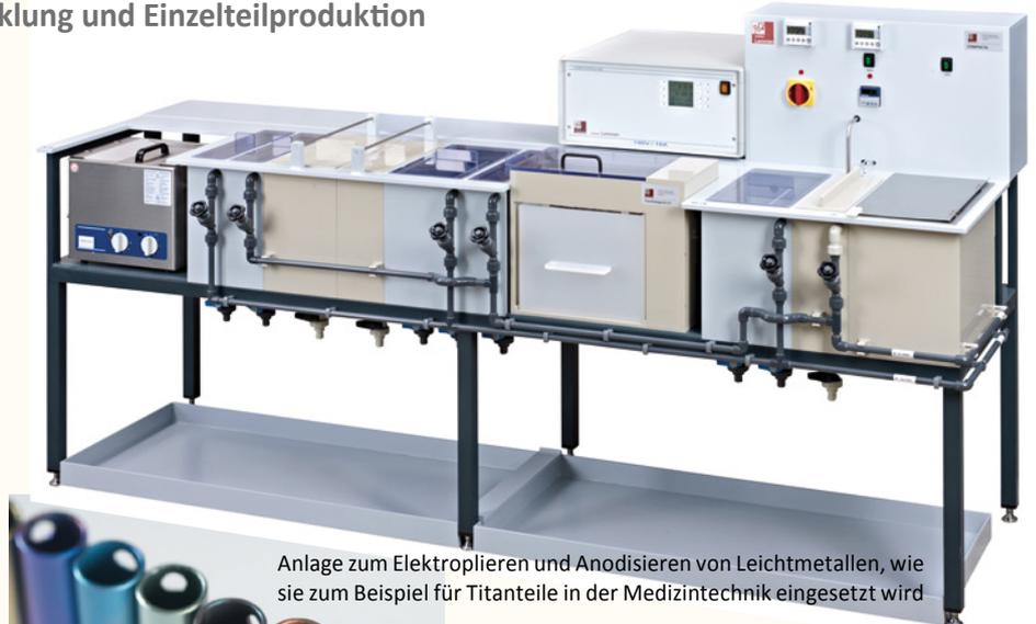
Anlage zum Elektropolieren und Anodisieren von Leichtmetallen, wie sie zum Beispiel für Titanteile in der Medizintechnik eingesetzt wird
