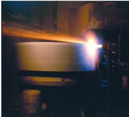
Abb. 4: Beim Lichtbogenspritzen mit elektrischer Energie entstehen sehr belastbare, fest anhaftende, hochtemperaturfeste und oxidationsresistente Oberflächen
