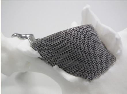
Abb. 2: Hüftpfannenimplantat aus dem 3D-Drucker mit drei individuell geformten Stützstrukturen
