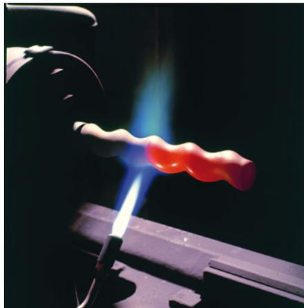
Abb. 2: Pulverflammspritzen erzeugt bis zu mehrere Millimeter dicke Schichtstärken, beispielsweise zum Zweck der Reparaturbeschichtung
