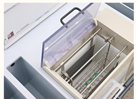
glänzende Oberfläche. Die modular aufgebauten Anlagen und Wannensysteme beinhalten sämtliche Behandlungsbecken für den gesamten Elektropolier- und Anodisierprozess, z.B. für Titan (*Bild oben*): Vorbehandlung (Ultraschall), Beizen, Elektropolieren, Spülen und Passivieren.
