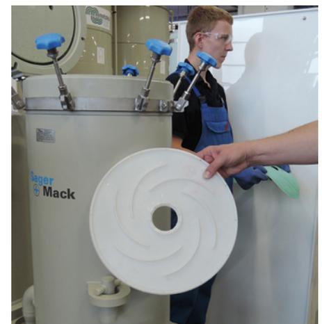
Einfaches Öffnen der Filtersäule und Tauschen des Filterpakets; eine wesentliche Neuerung ist die Leitstruktur auf den Platten des Filterpakts (rechts)
