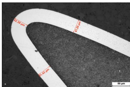
Abb. 1: Schichtdickenverteilung von chemisch abgeschiedenem Nickel
