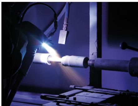
Abb. 5: Verschleißfest: Atmosphärisches Plasmaspritzen verarbeitet in der bis zu 20 000 °C heißen Plasmaflamme sogar hochschmelzende Keramiken
