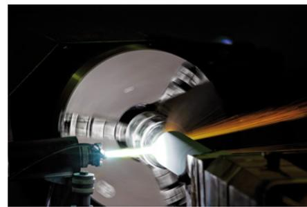
Abb. 7: Geringe thermische und hohe kinetische Energie bei HVOF-Spritzen führt zu guter Haftung und hoher Dichte der Schichten
