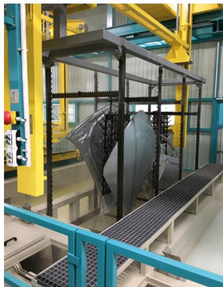
Fahrzeugteil in der KTL-Anlage
