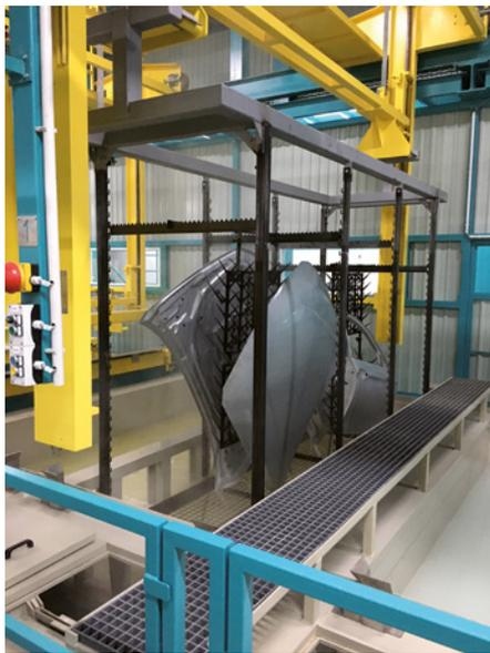
KTL-Beschichtung von Fahrzeugteilen 15
