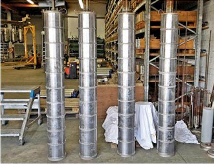
Abb. 3: Elektrolytisch vernickelte Galetten vor der Spritzbeschichtung
