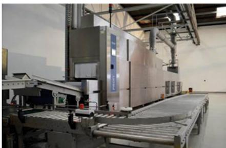
Die neue Teilereinigungsanlage bei Hartchrom kann problemlos unterschiedlichste Kistengrößen reinigen
