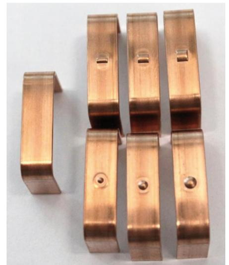
Probekörper mit den beiden untersuchten Strukturen Quelle: Dyck/Ulmer Gespräch
