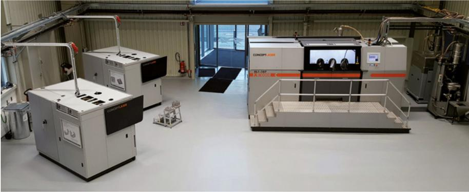
Additive Fertigung metallischer Teile bei Airbus
