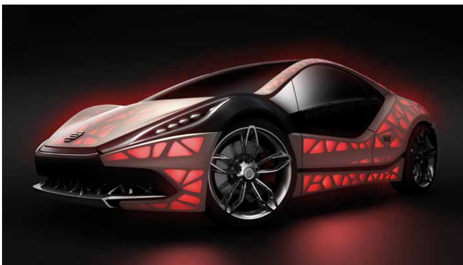
Das von EDAG auf dem Genfer Autosalon im März 2015 sowie auf der Internationalen Automobilausstellung IAA im September 2015 in Frankfurt präsentierte Concept Car EDAG Light Cocoon ; der EDAG Light Cocoon ist ein visionärer Ansatz eines kompakten Sportwagens mit einer umfassend bionisch optimierten und generativ gefertigten Fahrzeugstruktur, die mit einer Außenhaut aus wetterbeständigem Textil und variablem Lichtdesign kombiniert wird
