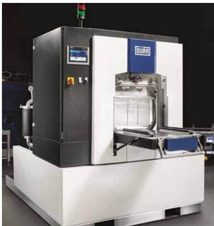
Das Aufstellmaß von nur 2100 x 1630 x 1855 mm (L x B x H) und ein geringes Gewicht ermöglichen es, mit der EcoCCube einen optimalen Einstieg in die wässrige Reinigung zu finden
