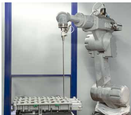
Der Hightech-Kolibri bei der seriensicheren Applikation von SafeCoat® garantiert trotz komplizierter Bauteilgeometrie, dass der Schutzlack auf schwer erreichbare Innenflächenbereiche exakt aufgebracht wird
