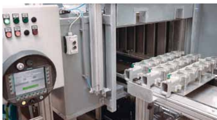
Perfektes Handling der Schutzlacke in der vollautomatischen Anlage, die in dieser Bauart einmalig in Europa ist; eingebracht wird eine funktionelle Beschichtung auf Basis von Fluorpolymeren
