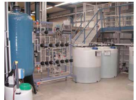
Anlage zur Entfernung von Aluminium aus Anodisierelektrolyten
