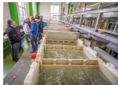
Phosphatierautomat, 24 x 16 m, mit Seitenläufer, Taktzeit 15 Min., Durchsatz 116 Teile/WT, mit teil-automatischer Regeneration für das Phosphatierbecken, im Probetrieb mit Wasser
