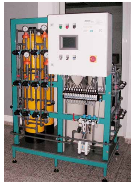
Anlage zur Entfernung von Fremdmetallionen aus Chrom(III)elektrolyten
