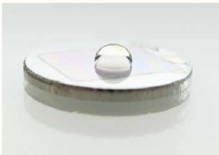
Weniger Anhaftung gewünscht: wasserabweisende Funktionsbeschichtung mit geringer Oberflächenenergie auf einem Edelstahlplättchen
