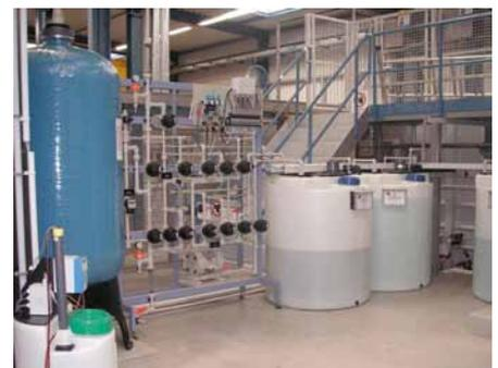
Anlage zur Entfernung von Aluminium aus Anodisiererelektrolyten
