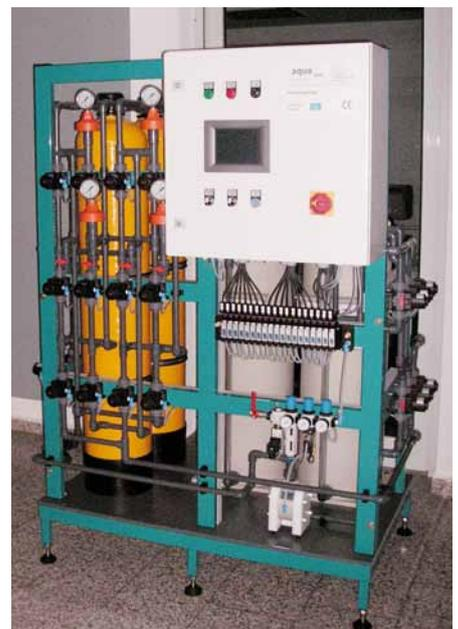
Anlage zur Entfernung von Fremdmetallionen aus Chrom(III)elektrolyten
