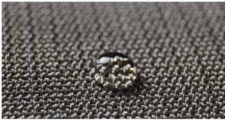
Abb. 3: Edelstahlgewebe mit WIBO-PROTECT
