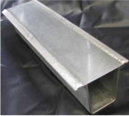
Metallschutzgaslötten von Stahl-Feinblech 4
