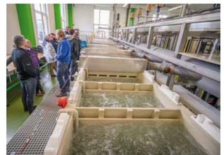
Phosphatierautomat, 24 x 16 m, mit Seitenläufer, Taktzeit 15 Min., Durchsatz 116 Teile/WT, mit teilautomatischer Regeneration für das Phosphatierbecken, im Probetrieb mit Wasser
