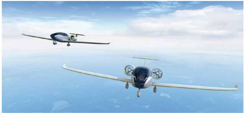
Der E-Fan Prototyp von Airbus wiegt 600 Kilogramm, ist 6,7 Meter lang und verfügt über eine Flügelspanne von 9,5 Meter. An Bord sind zwei Motoren vorhanden, die jeweils mit leistungsstarken Lithiumionenakkus angetrieben werden. Im Schnitt reist der Flieger mit 160 km/h; die Maximalgeschwindigkeit beträgt 220 km/h
