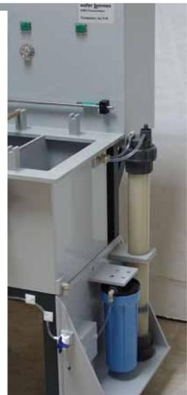
Ionenaustauscheranlage zur kontinuierliche Reinigung und Wiederverwendung von
