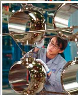
Nach dem DURNI-COAT®-Verfahren chemisch vernickelte Absperrkugeln
