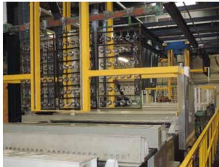
Blick auf die neue Anlagen bei MVB zur Stück- und Trommelbeschichtung mit Zink sowie verschiedenen Nachbehandlungen von Zinkoberflächen
