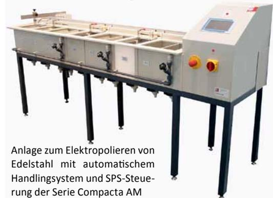
Anlage zum Elektropolieren von Edelstahl mit automatischem Handlingsystem und SPS-Steuerung der Serie Compacta AM
