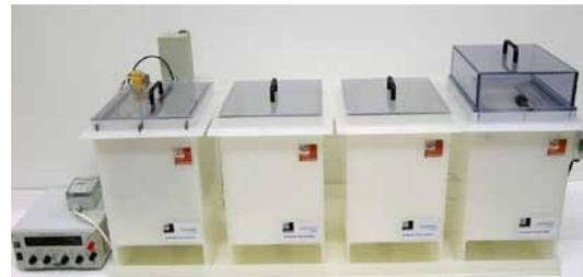
Modulare Tischgalvanisierwannen zum Elektropolieren von Kleinteilen
