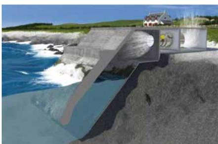
Abb. 3: Prinzip der Wellenenergienutzung durch oszillierendes Wasserniveau [8]
