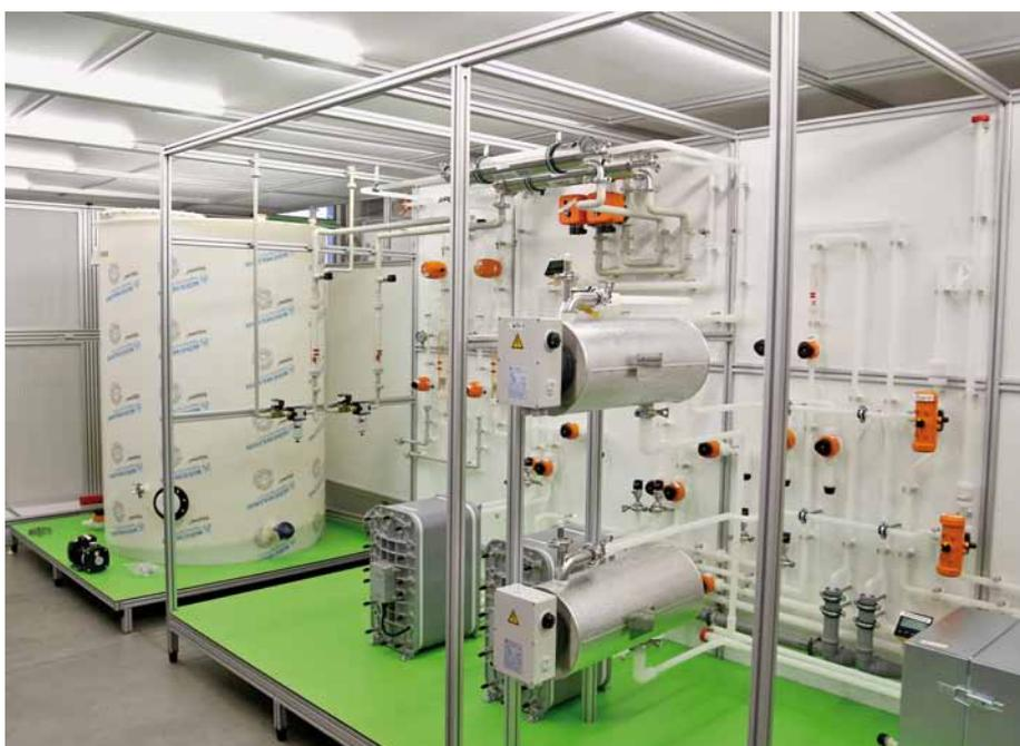
Abb. 7: Anlagen zur Wasseraufbereitung, die beispielsweise mit Umkehrosmose, Elektrodeionisierung oder Partikelfilter ausgestattet werden können
