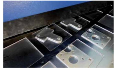
Abb. 7: Schablone für Kleinteile unter 150 mm Länge
