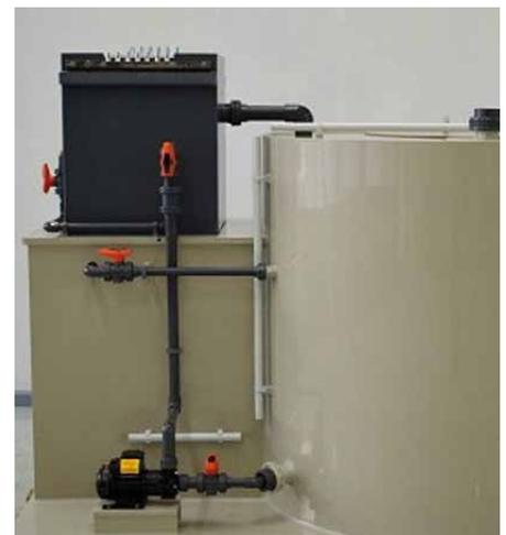
Elektrolysezelle mit Speicher als geschlossenes Recyclingsystem
