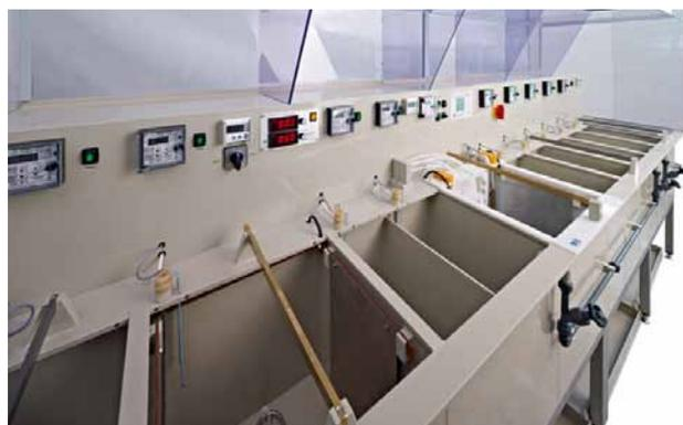
Manuelle Elektropolier- und Passivieranlage
