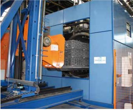
Eine Reinigungsflüssigkeit auf Basis modifizierter Alkohole wurde für die Flut- und Dampfreinigung in kombinierten Lösemittel- und wässrigen Reinigungsprozessen entwickelt und erfolgreich in der Lohnhärterei Schwäbische Härtetechnik Ulm GmbH (SHU) eingesetzt
