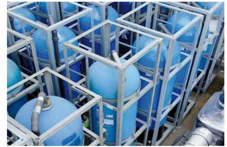
Abb. 5: Ionenaustauschersäule zur Erzeugung von großen Wassermengen für die mobile Regeneration Bild: Orben
