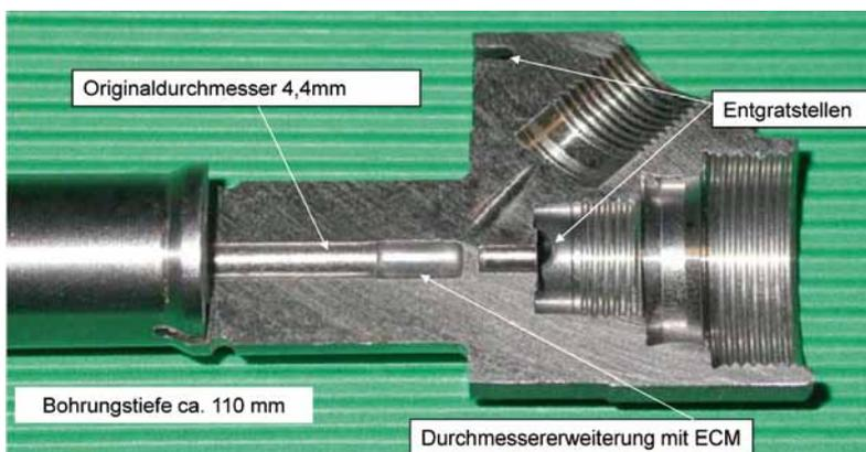
Bearbeitete Zonen eines Injektorkörpers aus Stahl für die Common-Rail-Einspritztechnik
