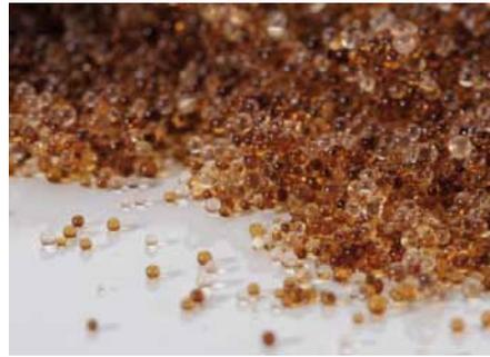
Abb. 4: Ionenaustauscherharz Bild: Orben
