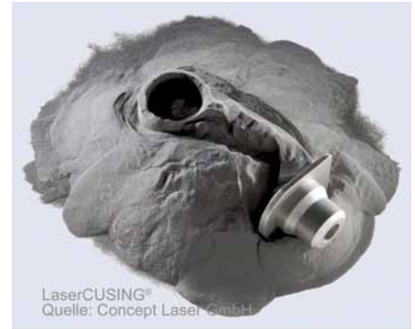
Großes industrielles Potenzial unter den additiven Verfahren: Laserschmelzen mit Metallen
