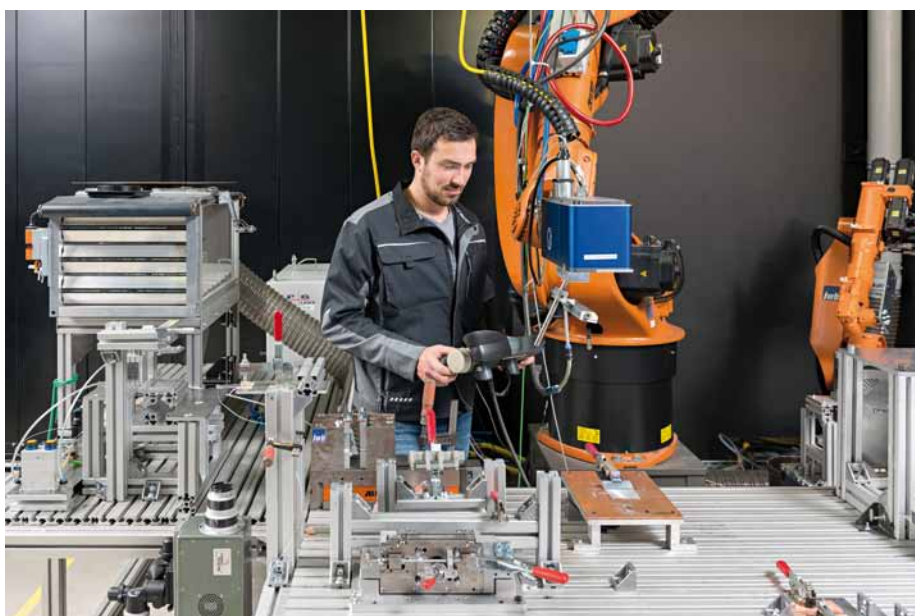
André Heckert, wissenschaftlicher Mitarbeiter am iwb, positioniert den Laser für die Bearbeitung des Metalls für das Fügen von Metall-Kunststoff-Verbindungen Foto: Ulrich Benz/TUM
