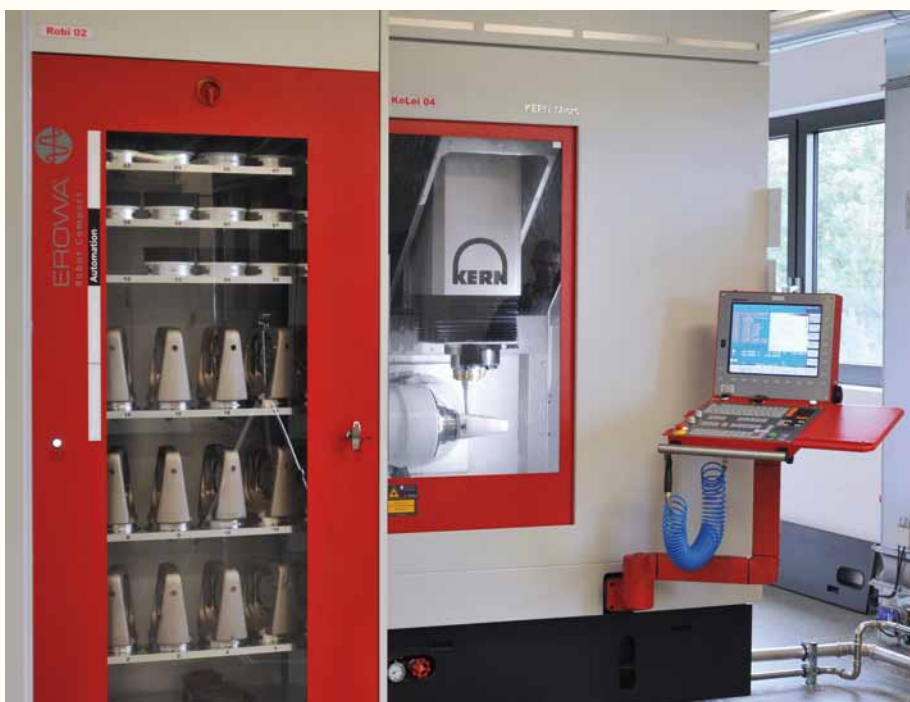
Präzision für Implantate: Mit inzwischen elf Fräsmaschinen des Typs Kern Micro fertigt etkon mit höchster Genauigkeit Teile für Zahnersatz Bild: etkon
