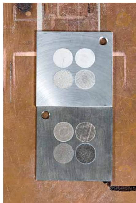
Oberflächenstrukturen, erzeugt durch Lasereinsatz Foto: Ulrich Benz/TUM
