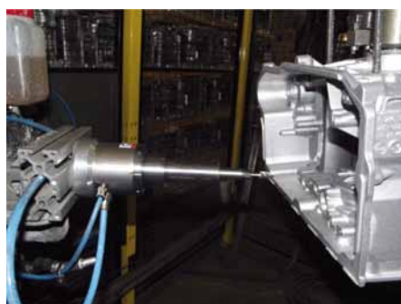
Roboterbasiertes Entgraten, bei dem das zu bearbeitende Teil an das Werkzeug geführt wird
