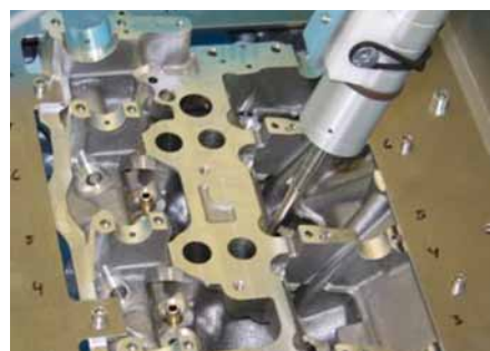
Kavitationsentgraten mit Roboterunterstützung Quelle: Rochowicz/deburring
