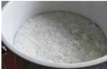
Abb. 8: Abgetrennte Kaliumsulfatkristalle nach Solvatisierung der zinnreichen Festphase
