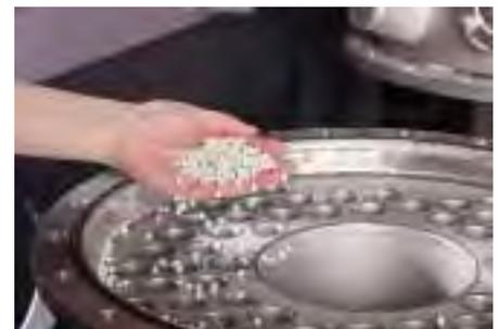
Das Activepowerclean-Wirbelgut sorgt für einen sauberen Wärmetauscher: Das Ergebnis sind weniger Wartungsaufwand und geringere Energiekosten
