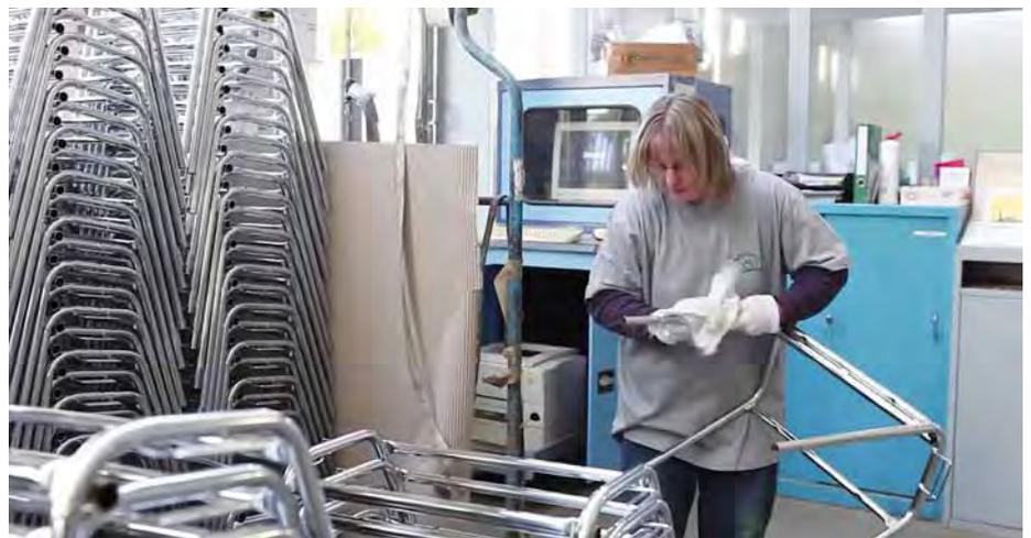
Stahlgestelle für Stühle werden nach mechanischer Oberflächenbehandlung in einem mehrstufigen Prozess galvanisch beschichtet (oben) und vor der Auslieferung als letzter Arbeitsschritt kontrolliert (unten)
