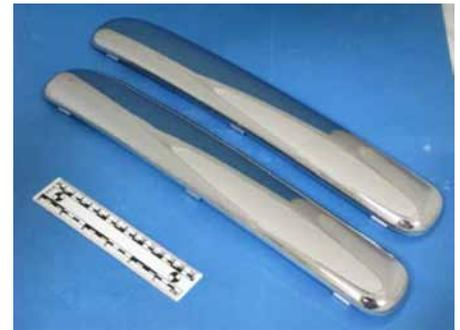
Testteile aus ABS und ABS/PC zeigen optisch keine Unterschiede
