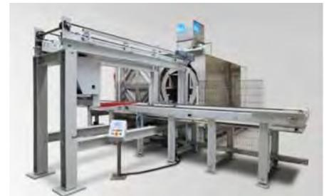
BvL-Korbreinigungsanlage NiagaraDFS mit Portalssystem zur Reinigung von Aluminium- und Stahlrohren in Eurogitterboxen bei Fischer Rohrtechnik
