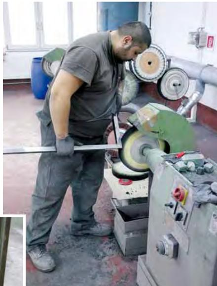
Durch Schleifen (oben links) und Polieren erhalten Metallteile eine hochwertige, glänzende Oberfläche; dabei kommen unterschiedliche Werkzeuge zum Einsatz
