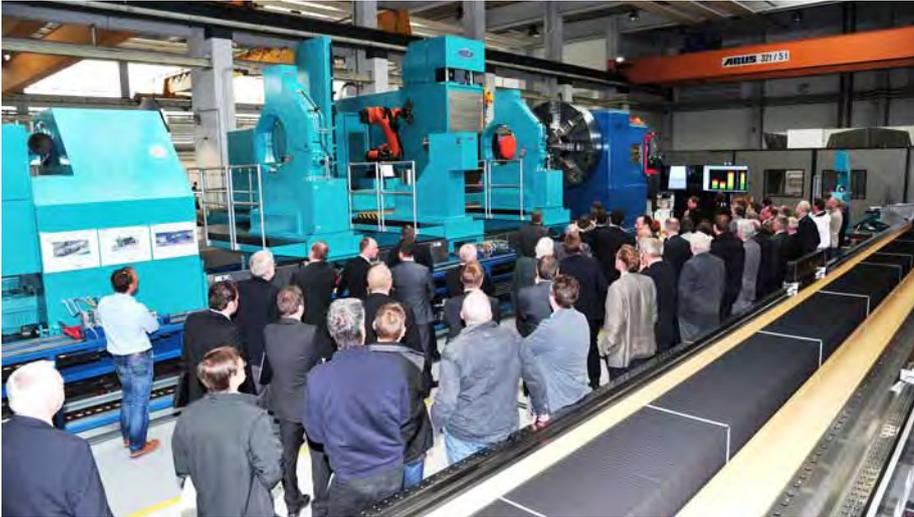
Horizontalbearbeitungszentrum für große Werkstücke bis 250 Tonnen Gewicht
