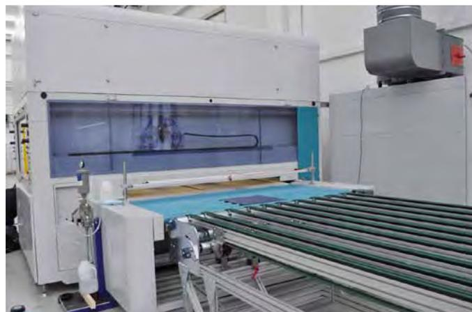
Aufbringung der Beschichtung im Spritzverfahren, manuell und automatisiert
