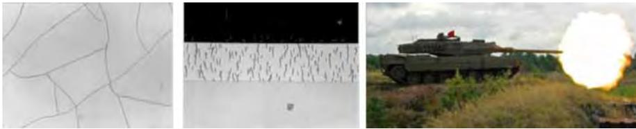
Abb. 2: Draufsicht und Querschliff einer Hartverchromung (Hartchrom AG) und Kampfpanzer mit verchromtem Waffenrohr beim Schuss
