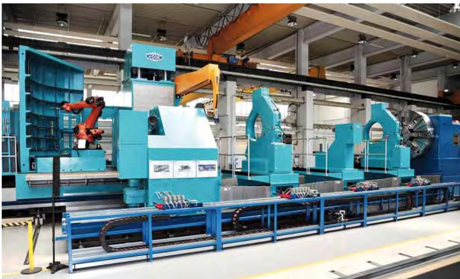
Die neue Maschine vor der Auslieferung an den Kunden – noch ohne Umhausung; die Werkzeugarena (links) fasst bis zu 106 Werkzeuge
