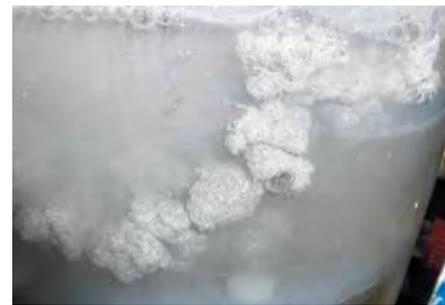
Abb. 9: Zinnabscheidungen im Glasreaktor bei fortgeschrittenem Reaktionsverlauf
