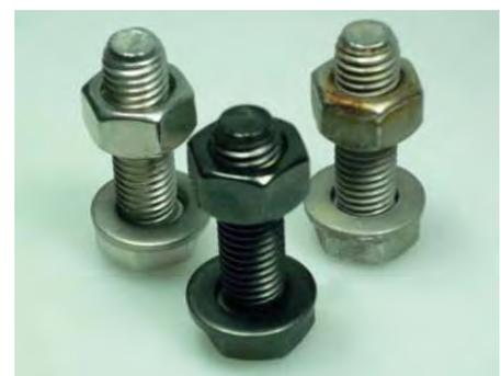
Abb. 2: Schrauben als Prüfteile in unterschiedlichen Stadien: unbeschichtet (links), beschichtet nach Auslagerung (Mitte) und unbeschichtet nach Auslagerung (rechts)
