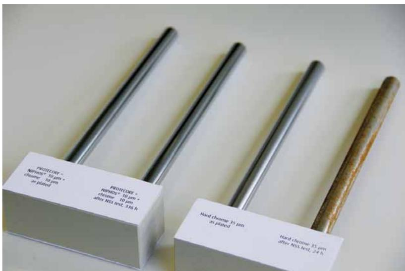
Überzeugend im NSS-Test: Keinerlei Anzeichen von Korrosion finden sich auch nach 336 h auf einem zweilagig beschichteten Stahlstab (2.v.l.), während der nur mit Chrom beschichtete Prüfling (ganz rechts) bereits nach 24 h deutliche Anzeichen von Korrosion zeigt
