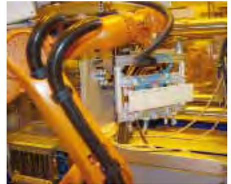
Automatisierte Fertigungszelle für die Herstellung von thermoplastbasierten Leichtbaustrukturen am Fraunhofer-PAZ © Fraunhofer-PAZ
