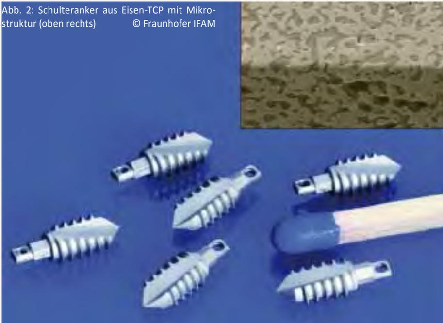
Abbildung 2 zeigt ein Demonstratorimplantat und eine elektronenmikroskopische Aufnahme der Mikrostruktur des Eisen-TCP-Komposits. Dabei ist die hellere Phase das Eisen und die dunklere Phase das TCP.
