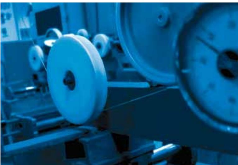
Der Durchzug von Drahtmaterial durch die galvanische Anlage erfordert umfangreiche Einrichtungen für die Drahtführung und die Überwachung der Zugkräfte
