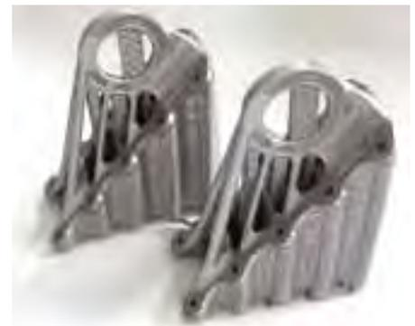
Abb. 4: Effekte durch Variation der Laserleistung am Beispiel des Kabinenhalter Bracket des Airbus A350 XWB der Airbus Operations GmbH: Der Defekt ist optisch nicht erkennbar, wird aber durch die Prozessdaten von QMmeltpool 3D erschlossen (rechts das Bauteil mit geringer Laserleistung, links das Bauteil mit Standard-Leistung)
