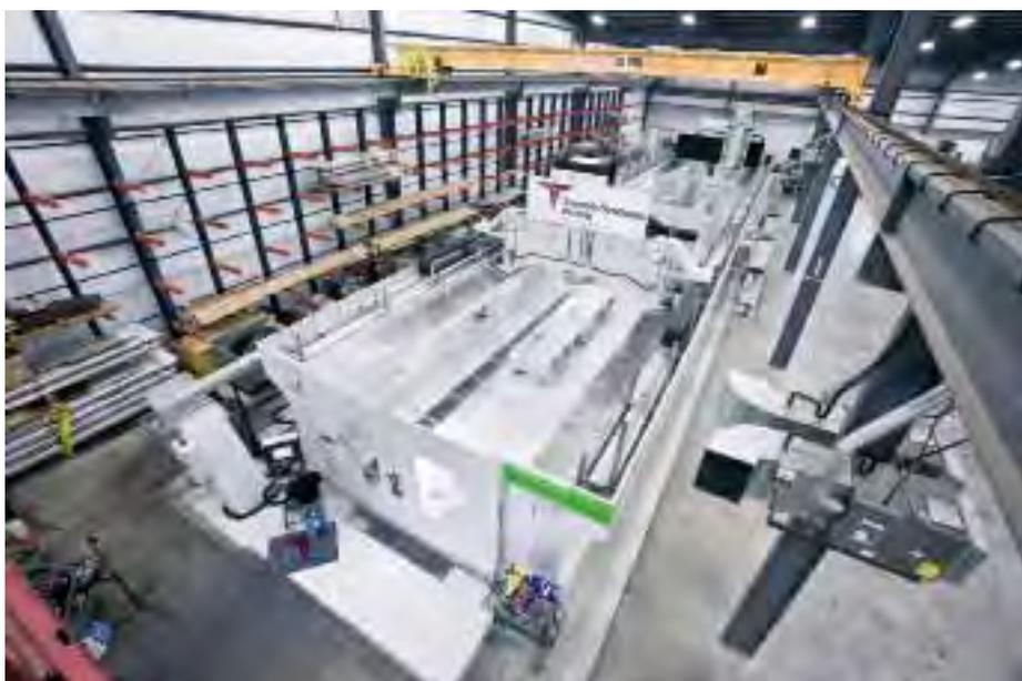
Mit der optimierten Portalfräsmaschine FZ100 lassen sich einzelne Bauteile mit einer Gesamtlänge von mehr als 25 Metern bearbeiten und auch zwei kleinere unabhängig voneinander Bild: Siemens/USA
