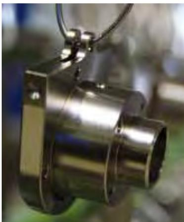
Aus Aluminium gedrehte und gefräste Bauteile mit komplexer Geometrie und zahlreichen Passungen erhalten eine hochpräzise chemische Vernickelung für ihren Einsatz in medizinischen Diagnostikgeräten
