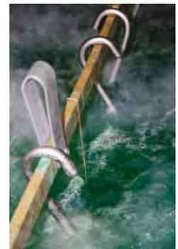
Stopfen verschließen Bohrungen, die nicht chemisch vernickelt werden sollen (li.); als Gestellware bewegen sich die Hydraulikzylinder per Kran durch die Bäderstraße (Mitte); die 800 mm großen Hydraulikzylinder gehen zum Vernickeln auf Tauchstation in das mit Druckluft zum Sprudeln gebrachte Bad (re.)
