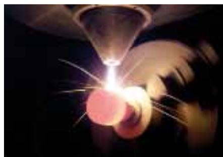
Abb. 1: Laserpulverauftragschweißen an rotations-symmetrischem Bauteil
