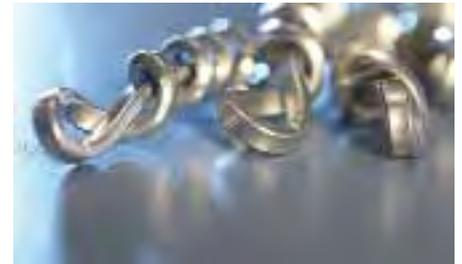
Die Beschichtungen besitzen eine sehr gute Haftung auf dem Grundwerkstoff und eine hohe Duktilität, wodurch die beschichteten Produkte sehr gut mechanisch verformbar sind
