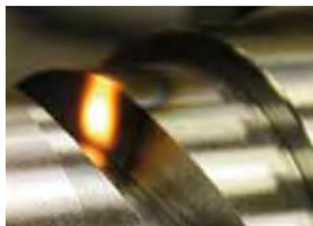
Abb. 2: Laserhärten an einer scharfkantigen Geometrie
