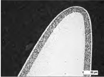
Abb. 2: Oberfläche aus einer chemisch abgeschiedenen Nickel-Diamantbeschichtung mit Nachvernickelung
