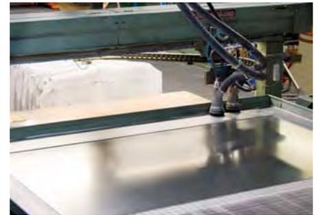
Hierdurch ist das Unternehmen in der Lage, Bleche bis zu einer Größe von 6,05 m Länge und 2,36 m Breite zu polieren und zu mattieren. Es ist möglich Heizplatten zu bearbeiten. Auf Wunsch kann auch eine Komplettaufarbeitung durchgeführt werden.
