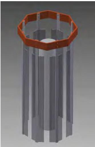
Abb. 2: Durch Hochtemperaturelektrolyse mit Platin beschichtete Titananoden sind dimensionsstabil; sie bewahren über einen langen Zeitraum ihre Form
