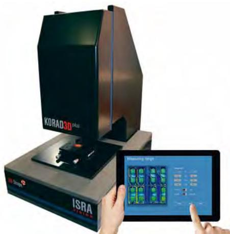
KORAD3D<sup>plus</sup> – integrierter x/y-Tisch, bis zu 100 mm Scan Range, integrierte Evaluationssoftware, Touch-Bedienfeld, Stitching Technologie, anpassbares Sichtfeld
