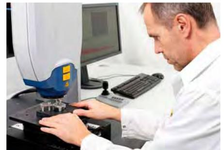
Abb. 1: Das Messsystem erlaubt die gleichzeitige Erfassung aller Bewegungskomponenten mit nur einem Messstrahl und einer Schwingungsamplitudenauflösung im Pikometerbereich Bild: Polytec
