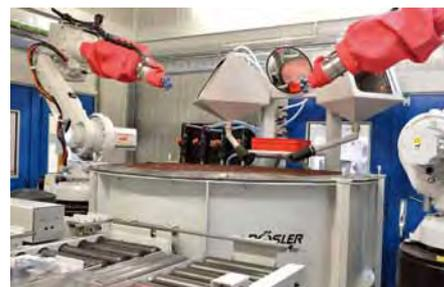
Beim Surf-Finishen, bei dem das Werkstück durch einen Roboter in mit Schleifmedium gefüllten, rotierenden Arbeitsbehälter geführt wird, können bestimmte Bereiche selektiv oder durch unterschiedliche Positionen des Roboterarms verschiedene Radien bearbeitet werden (Bild: Rösler)
