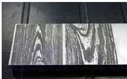
Schichtdicken mit weniger als 2 µm sind möglich, genauso wie das Abbilden organischer Strukturen, wie eine Holzmaserung (Bild: Reichle)
