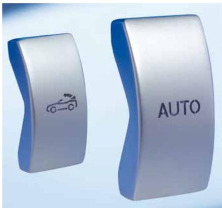
Abb. 2: Schalterkappe (Schalterwippe) mit integrierten hinterleuchteten Symbolen aus Zinkdruckguss mit fließend variierenden Wandstärken (Quelle: Initiative Zink)
