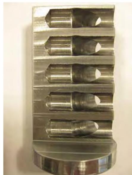
Das neue CBD-Verfahren ermöglicht die automatisierte Entgratung von sich kreuzenden Öllochbohrungen in beliebigem Bohrverhältnis und mit Durchdringungswinkeln deutlich kleiner 90° (Bild: Heule Werkzeug AG)
