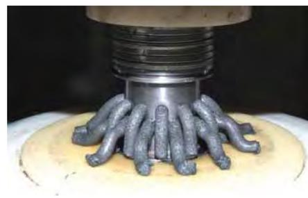
Beim Strömungsschleifen erfolgt die Bearbeitung mit Schleifkörnern, die in eine polymere Kunststoffmasse mit definierter Viskosität eingebettet sind (Bildquelle: Perfect Finish)
