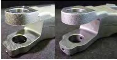
Das thermische Entgraten entfernt innerhalb weniger Millisekunden alle Grate (links) vollständig, wobei die Gratwurzel versiegelt wird (rechts) (Bild: ATL)
