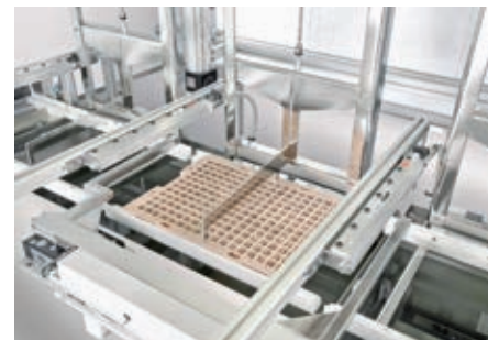
Bei Feinstreinigungsaufgaben, beispielsweise bei Maschinenwerkzeugen vor der Beschichtung, sorgen verschiedene konstruktive Details wie der von UCM entwickelte Vierseitenüberlauf für eine konstant hohe Teilesauberkeit Foto: Dürr Ecoclean
