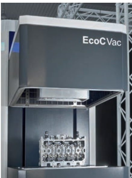
Das innovative Trockenreinigungssystem EcoCVac wurde für die energiesparende Zwischenreinigung von Powertrain-Bauteilen entwickelt. Es arbeitet ohne Druckluft Foto: Dürr Ecoclean
