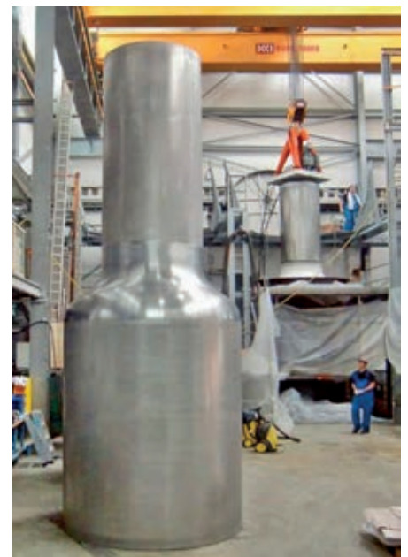
Kolben einer Stahlpresse (67 T) mit Nickeldispersions-schicht (30 µm)
