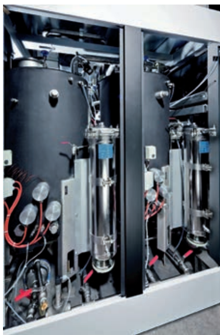
Durch die stehend angeordneten und strömungsoptimierten Medienbehälter ermöglicht die EcoCWave in neuer Zweitank-Ausführung eine höhere Reinigungsqualität bei gleichzeitig verlängerter Badstandzeit Foto: Dürr Ecoclean
