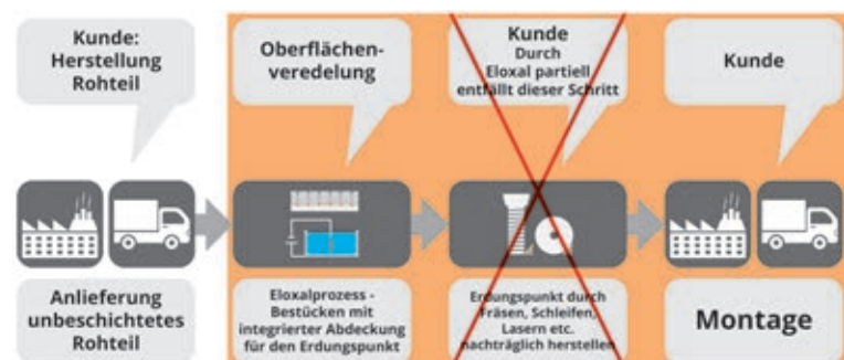
Abb. 3: Vergleich der erforderlichen Verfahrensschritte bei der bisher üblichen Technik und Eloxal partiell plus
