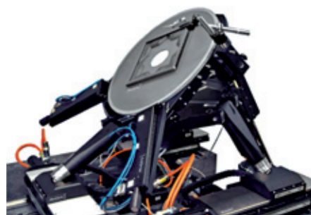
Abb. 4: Symmetrisch aufgebaute, sechssachsige Parallelkinematik, wobei jeweils drei Beine mit fester Länge an der Plattform angreifen, die wiederum jeweils von einer XY-Tischkombination getragen werden Foto: PI
