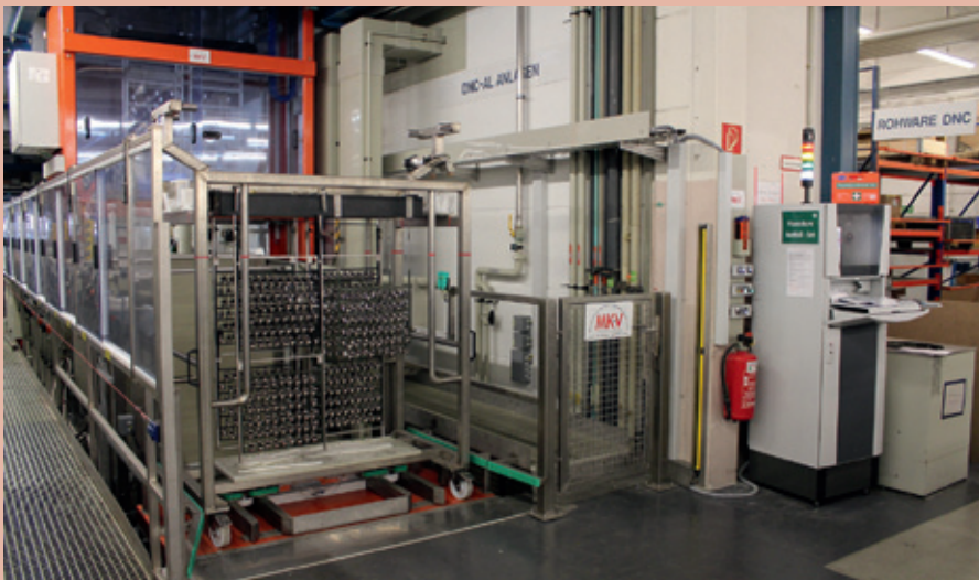
Die neue Anlage mit Verfahrwagen zur chemischen Vernickelung von Aluminium und Aluminiumlegierungen im AHC-Werk München
