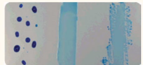
Abb. 56: Bestimmung der Oberflächenspannung (OS) mit Testtinten [62]; OS-Testtinte > OS-Substrat (links), OS-Testtinte = OS-Substrat (Mitte) und OS-Testtinte < OS-Substrat (rechts)
