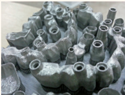
Mit der Metall-Laserschmelztechnik gefertigte Abutments, Kronen und Brücken von Fresdental (Dentalteile mit Stützkonstruktionen auf Bodenplatte)
