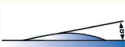
Abb. 55: Ein kleiner Kontaktwinkel (links) bedeutet eine gute Benetzbarkeit, ein großer das Gegenteil (rechts) [61]
