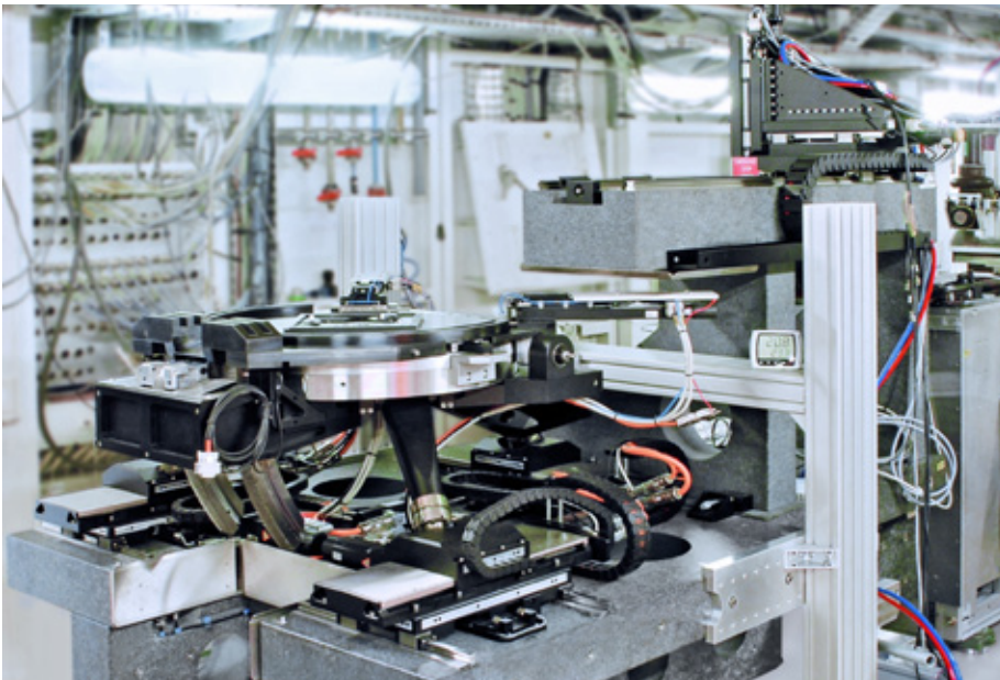
Abb. 3: Detektor- und Probenpositionierung aus drei kooperierenden Systemen: Hubtisch mit Granitunterbau, in drei Achsen beweglicher Detektortisch und Probenpositionierung Bild: PI, Fh-EZRT, ESRF
