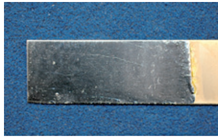
Abb. 3. Dip-and-Look-Lötestest ohne Entnetzung
