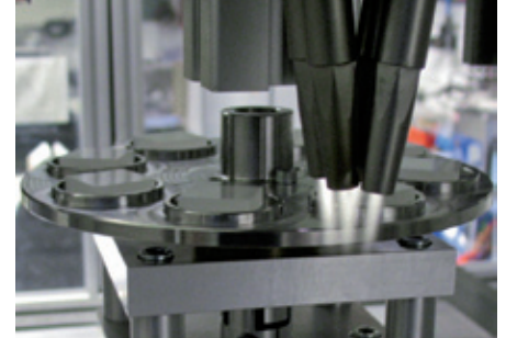
Plasmaunterstützte Vorbehandlung von acht Kunststoff-Prüfkörpern auf einem rotierenden Halter Bild: Innovent e. V.
