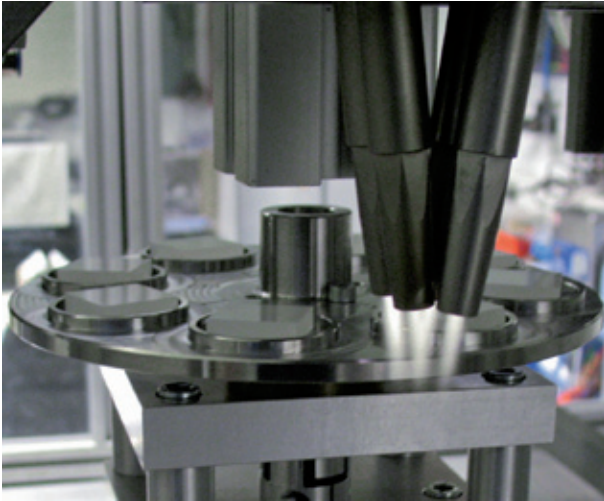
Plasmaunterstützte Vorbehandlung bei Kunststoffteilen
