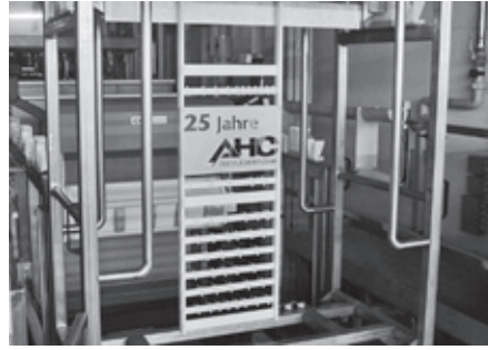
Chemisch vernickelte Aluminiumplatte mit eingelasertem Schriftzug auf einem neuartigen Kunststoffgestell
