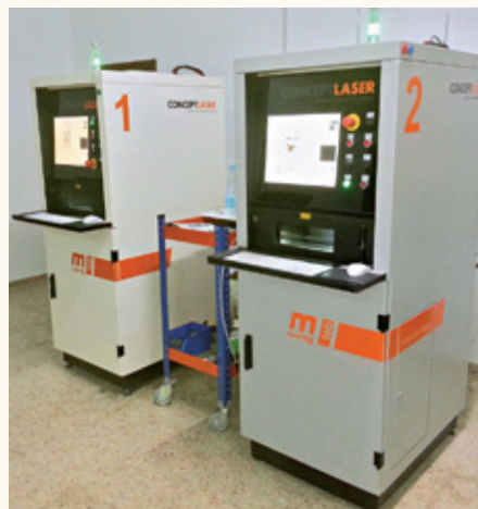
Laserschmelzanlagen Mlab cusing bei Fresdental Foto: Fresdental
