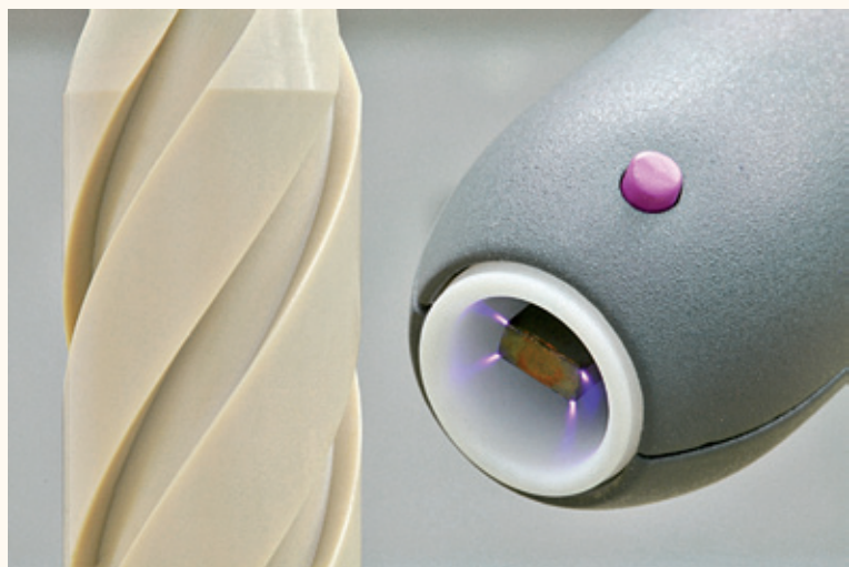
Durch die Plasmafunktionalisierung werden eventuell auf der Implantatoberfläche vorhandene Mikroorganismen zerstört und gleichzeitig die Oberflächenenergie erhöht, sodass sie für Blut und andere Körperflüssigkeiten besser benetzbar wird
