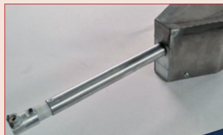
Eigenentwickelter Innenbrenner für Innenbeschichtungen bis \varnothing 60 mm Foto: T-Spray
