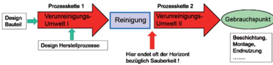
Abb. 2: Ermittlung der Verschmutzungsquellen im Prozess
