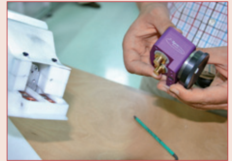
Brennerstudie: Mit wenigen Handgriffen kann der ganze Brennerkopf getauscht werden Foto: T-Spray
