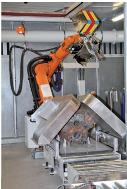
Vollautomatischer Lichtbogenbeschichtungsprozess mit automatisiertem Brennerwechsel für Haft- und Deckschicht Foto: T-Spray
