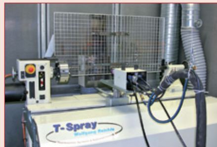
Automatisierter Versuchsspritzstand für Flächenbeschichtungen bis 1000 mm x 600 mm oder Rotationsbeschichtungen mit Durchmesser von 200 mm x 1000 mm und mitgeführtem Lufterfassungselement zur konzentrierten Absaugung
