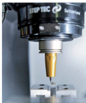
Mit Fräswerkzeugen von nur 0,1 mm Durchmesser werden mit bis zu 42 000 U/min Konturen in Stempel und Matrizen für die Hochleistungswerkzeuge gefertigt Bild: www.iwsphotostudio.de
