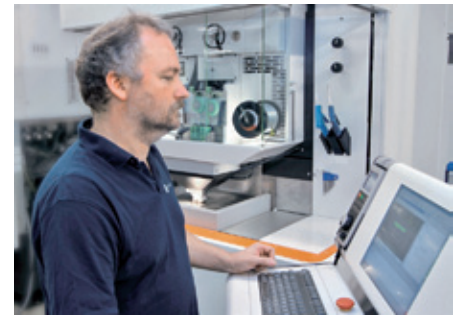
Gerd Renninger von Leicht + Müller: Wir erreichen auf der CUT 1000 eine Oberflächengüte mit einem mittleren Rauwert von Ra 0,1 Bild: www.iwspostudio.de
