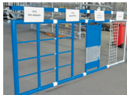
Musterbeschichtung auf verzinktem Untergrund
