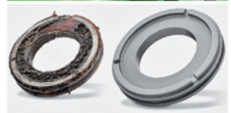
Eine Fettrückhaltescheibe ist nach dem Trowalisieren perfekt gereinigt (oben); unten im Zustand vor und nach der Behandlung
