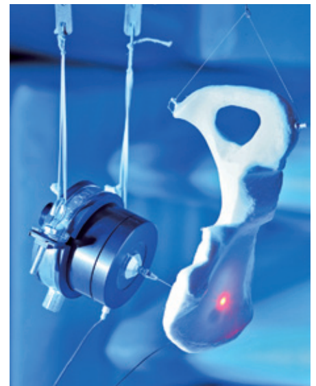
Durch elektrodynamischen Shaker angeregtes Hüftbein zur Modalanalyse für die biomechanische Charakterisierung
