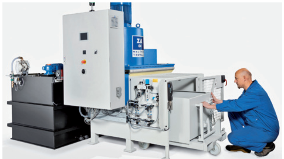
Die Zentrifuge ZA 04 für die Aufbereitung des Prozesswassers
