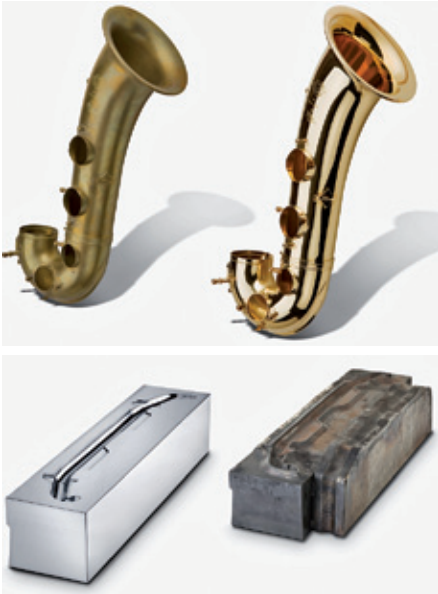
Anwendungsbeispiele: Ein Musikinstrument aus Messing (oben) sowie eine Schmiedeform jeweils vor und nach dem Trowalisieren (unten)
