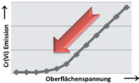
Abb. 3: Korrelation von Oberflächenspannung und Chrom(VI)emission
