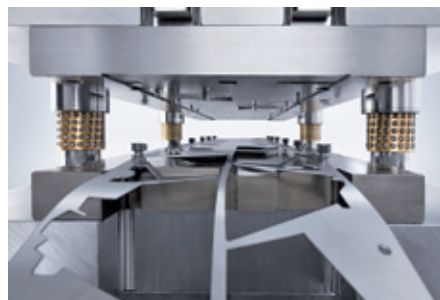
Stanzwerkzeug (li.) und kleiner Auszug an Blech-, Drahtbiegeteilen und Kontaktfedern von Bürkle
