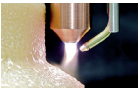
Das LDPE wird über einen externen Injektor dem Plasmastrahl zugeführt und abgeschieden
