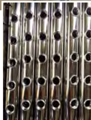
Die neue Elektropolieranlage sowie einige der von der Strähle Galvanik GmbH elektropolierten Teile
