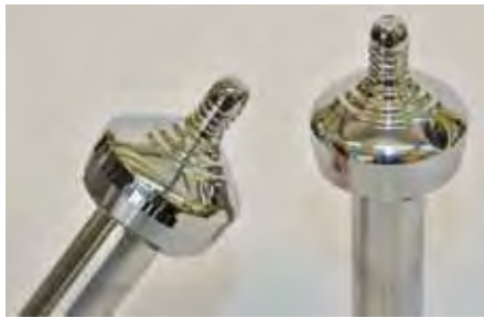
Hochglanzpolierte und beschichtete Spritzformen mit sehr guter Entformbarkeit
