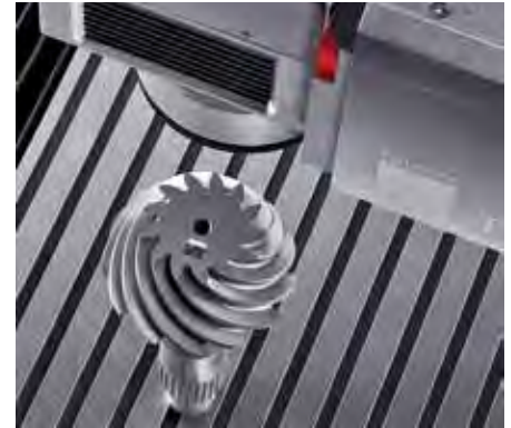
Markieren eines Kegelrads mit einem Präzisionslasersystem von Trumpf Bild: Trumpf
