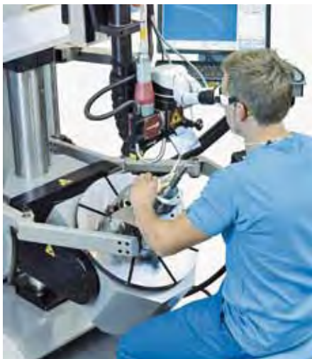
Durch eine integrierte Schwenkachse können Werkstücke stets in einer ergonomischen Arbeitshöhe platziert werden. Bild: Schunk Lasertechnik
