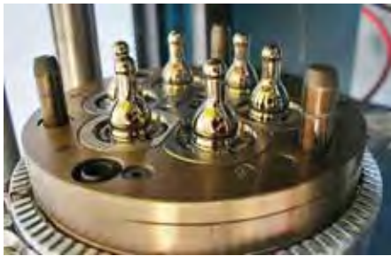
Hochglanzpolierte und beschichtete Spritzformen mit sehr guter Entformbarkeit
