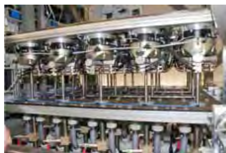
Abb. 1: Anlage zur Maßverchromung mit hoher Geschwindigkeit (li.) und verchromte Kolbenstange (re.)
