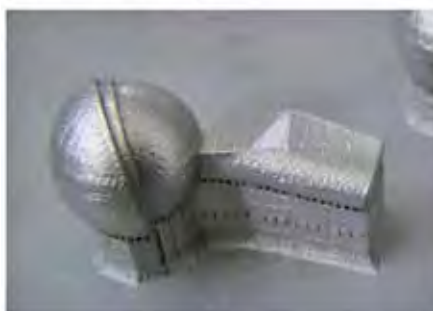
Aktive Qualitätssicherung mit dem QMmeltpool: Für das menschliche Auge ist kein Fehler erkennbar, im Gegensatz zur maschinellen Beurteilung Bild: Concept Laser GmbH
