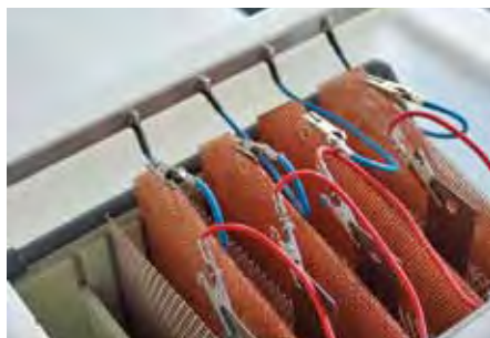
Rückgewinnungsmodul TG-MRM6 für Edelmetalle (links) und Spezialkathoden und -anoden für eine optimale Abscheidungsrate (rechts)
