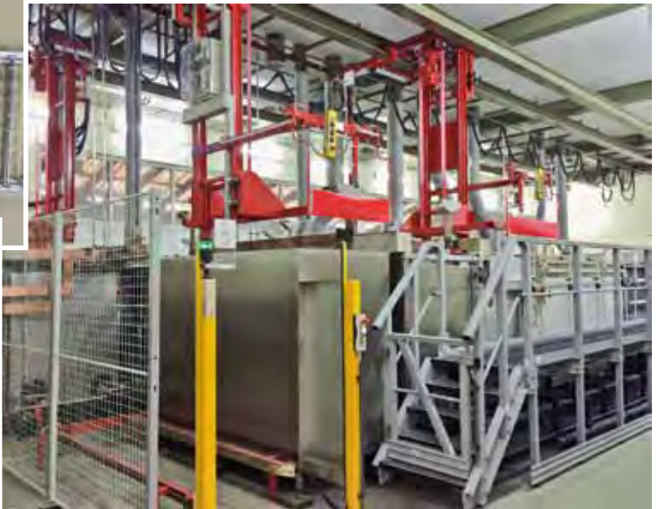
Die neue Elektropolieranlage sowie einige der von der Strähle Galvanik GmbH elektropolierten Teile
