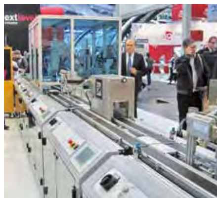
Abb. 1: Modulare Anlage mit Steuerungssoftware, welche die Befehle für die Bearbeitung an den einzelnen Stationen aus den Daten generiert, die mit dem Werkstück mitlaufen; die Realisierung erfolgte hier durch SAP
