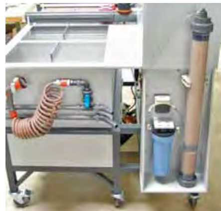
Ionenaustauscheranlage zur kontinuierlichen Reinigung und Wiederverwendung von Spülwasser als Standmodell oder integriert in Anlagen
