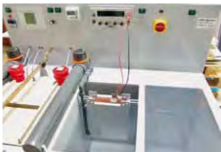
Rückgewinnungsmodul TG-MRM6 für Edelmetalle (links) und Spezialkathoden und -anoden für eine optimale Abscheidungsrate (rechts)
