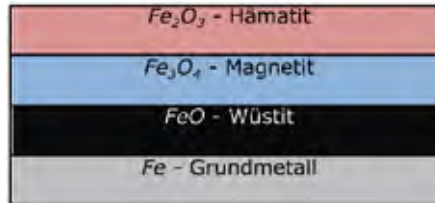
Abb. 1: Schematische Darstellung einer Zunderschicht auf Eisen
