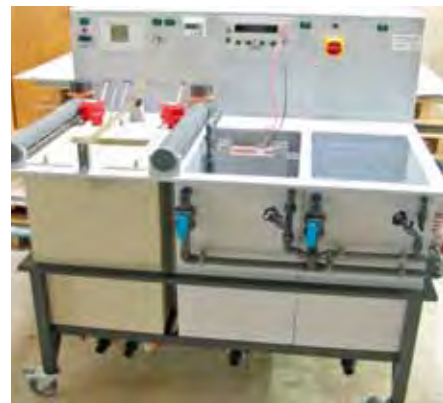
Kleingalvananlage für die Palladiumabscheidung mit integrierter Elektrolysezelle
