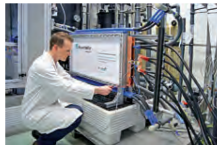
Durch ein neues Design ist es gelungen, die Größe und Leistungsfähigkeit der Batteriestacks zu erhöhen Bild: Fraunhofer UMSICHT
