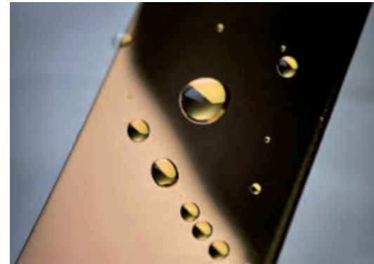
Wassertropfen auf einer Stahloberfläche mit Anti-Fouling-Beschichtung Quelle: Fraunhofer IST
