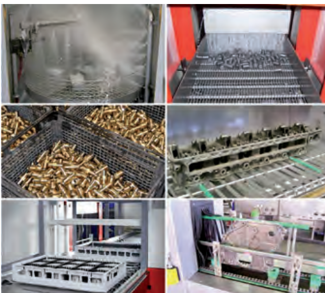
Teilereinigung durch Spritzen, Vollbad und Ultraschall – innovative Verfahrenstechnik sichert technische Sauberkeit
