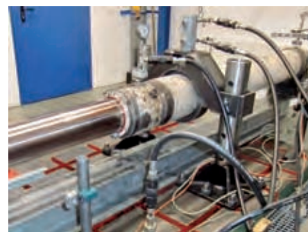
MTV MProtect beim Querlastversuch
