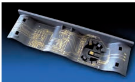
MID-Bauteil (MID-TRONIC Wiesauplast GmbH)
