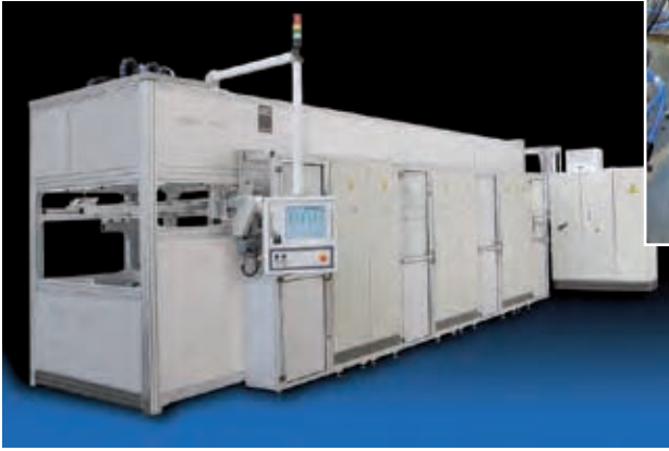
Geschlossene GST-Anlage mit Prozesszelle und Handlingsystem
