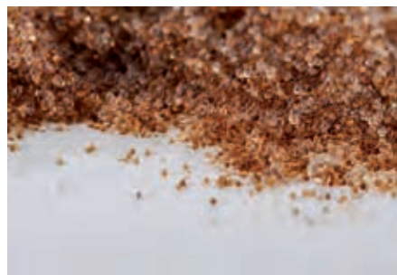
Ionenaustauscherharz, wie es in den Patronen von Orben Anwendung findet
