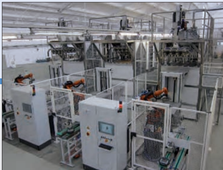
GST – Hartchrom-Beschichtungsautomat Kapazität 20.000 Kolbenstangen/Tag
