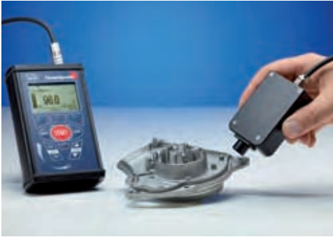
SITA CleanoSpector – organische Restverschmutzungen auf Oberflächen lassen sich zuverlässig und einfach detektieren
