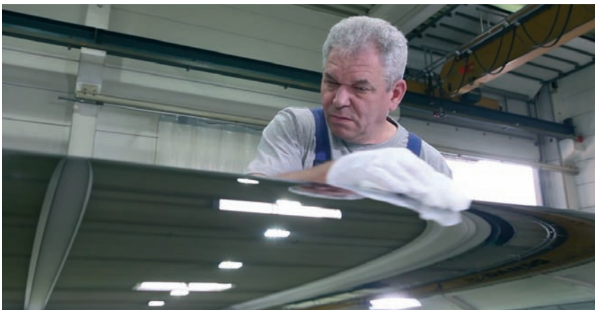
Abb. 5: Mechanisch polierte, mit Chrom beschichtete Walze (Bild: LKS Kronenberger)
