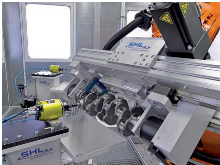
In der werkstückgeführten Variante bewegt der Roboter die Kurbelwelle zu den jeweiligen Bearbeitungsstationen
