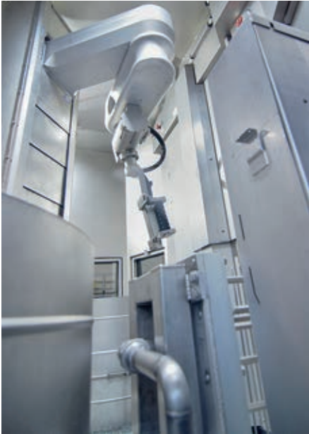
Der Manipulator besteht komplett aus hochfestem Aluminium und Edelstahl und benötigt weder Lackierung noch Schutzjacke Bild: Dürr Ecoclean
