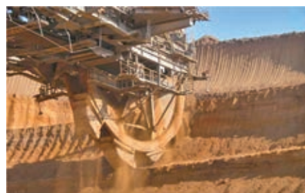
Beschichtung von Schaufeln durch thermisch Spritzen für Braunkohlebacker oder Wasserkraftwerke
