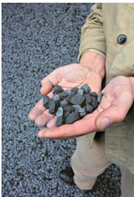
Aufbereiteter Sekundärrohstoff aus Schlacke ©Fraunhofer-UMSICHT
