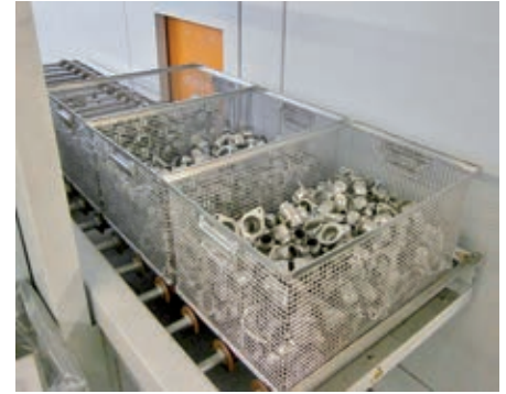
Die Werkstücke werden als Schüttgut gereinigt, wobei Vorgaben zur technischen Sauberkeit von kein Partikel oder Schnittgrat größer 400 µm zu erfüllen sind Bild: Roll, Mayr + Hönes
