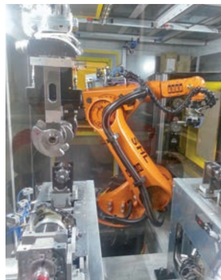
Das Werkstück wird in eine Spannvorrichtung gelegt und der Roboter bearbeitet es anschließend mit Werkzeugen
