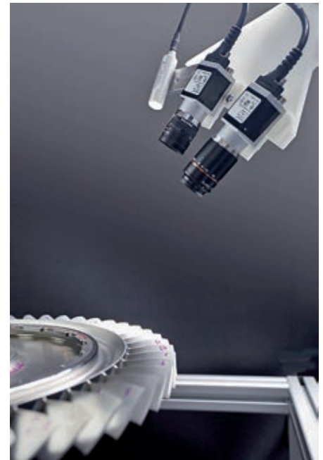
Prototypische Inspektion der Oberfläche einer BLISK (Bladed Integrated Disk) mit zwei Kameras und einer Beleuchtung © Fraunhofer-ITWM
