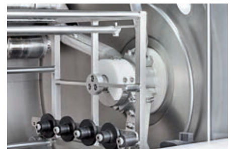
Wesentliche Kriterien für die Wirkung des Spritzverfahrens sind Form und Anordnung der Düsen sowie der Spritzdruck Bild: MAFAC
