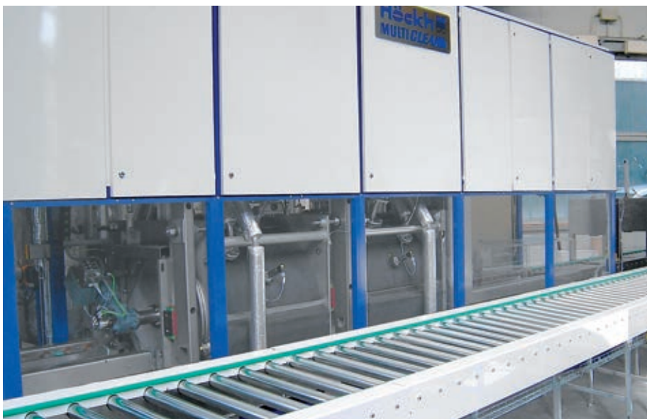
Durchlaufanlage für die Endreinigung von Schaltplatten, bei der die gereinigten Teile direkt in einen Reinraum zur Montage gelangen Bild: Hoeckh
