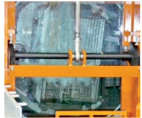
Teile mit komplexer Geometrie (z.B. Sacklochbohrungen oder Hinterschneidungen) werden bevorzugt im Tauchreinigungsverfahren gereinigt, wobei Drehen der Teile im Reinigungsbehälter die Reinigungswirkung verstärkt Bild: Hoeckh
