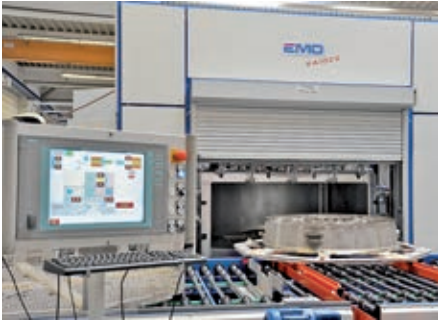
Das Reinigungssystem mit Verfahren wie Druckumfluten, Ultraschall sowie Drehen des Werkstücks um die eigene Achse ermöglicht die Kombination von Reinigungsschritten mit wässrigen Medien und Lösemitteln in einer Anlage Bild: EMO
