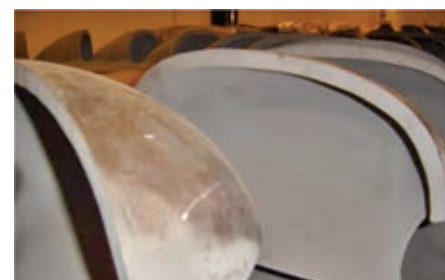
Beschichtung von Schaufeln durch thermisch Spritzen für Braunkohlebacker oder Wasserkraftwerke
