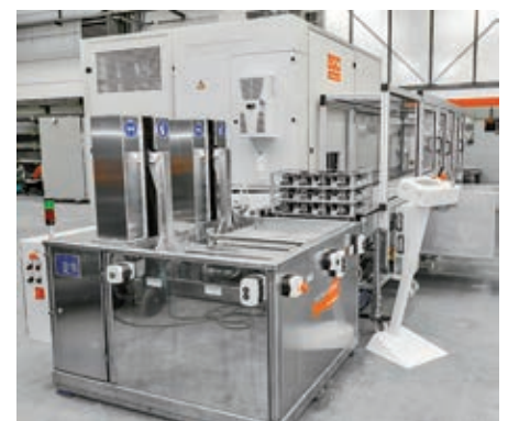
Anlage für die wässrige Endreinigung von Einspritz-Pumpenteilen mit der Spezifikation von maximal zwei metallische Partikel im Bereich 300 µm bis 500 µm und maximaler Gesamtrestschmutz < 5 mg/Bauteil Bild: LPW
