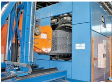
Reinigung mit einem neuen Lösemittel, das durch seine verringerte Wasserlöslichkeit den Verbrauch in den Kombinationsprozessen reduziert
