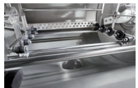
Der rotier- und positionierbare Ultraschall kann kritische Teilegeometrien gezielt ansteuern
