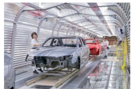
LED-Lichttunnel zur Prüfung der lackierten Karosserien Quelle: Audi AG
