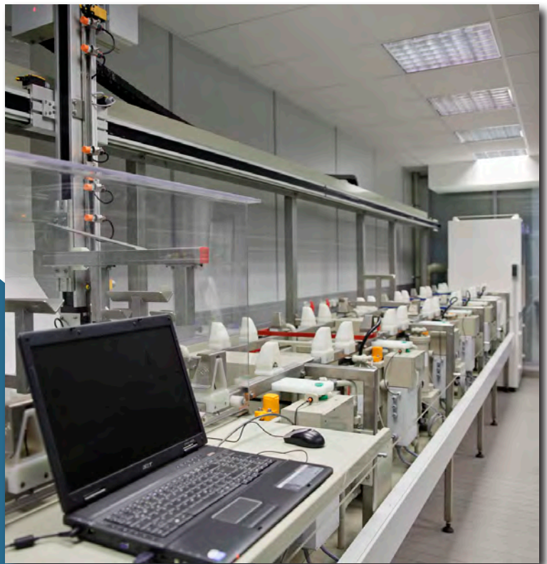
Galvanikanlage zur Optimierung von Abscheideverfahren am Fraunhofer IPA in Stuttgart
