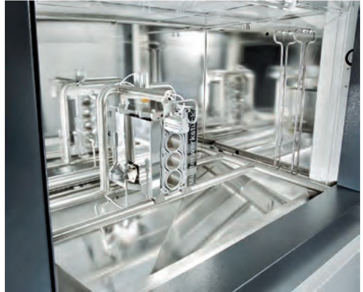
Sauberkeitsprüfung nach VDA 19 12
