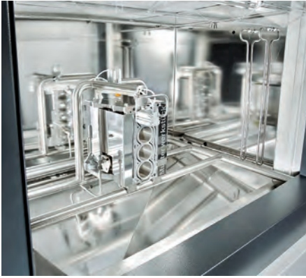
Das innovative EcoCLab ermöglicht es, die Sauberkeitsprüfung nach VDA 19 vollautomatisch inline durchzuführen
