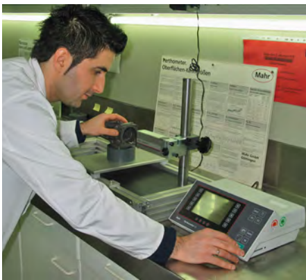
Abb. 2: Rautiefenmessung mittels Perthometer
