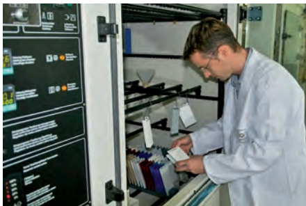
Probenbeurteilung bei Kurzzeitkorrosionstest
